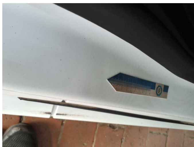
Damage 9: Side panel - rear right side: Sill (Mit Dellen) - Scratch(es) - Smart repair
