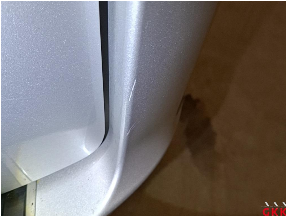
Bild 31 Stoßfänger hinten, Ecke rechts -lackiert-, verkratzt, lackieren
