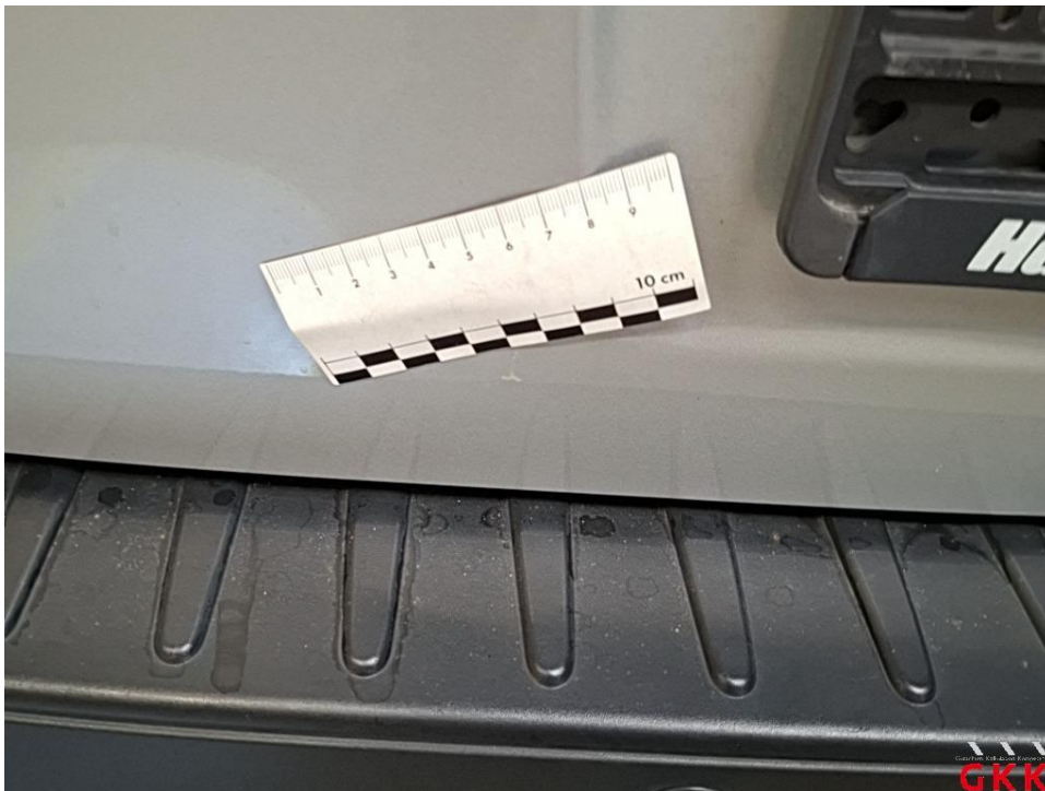
Bild 28 Heckklappe, unterhalb, verkratzt, Spotlackieren
