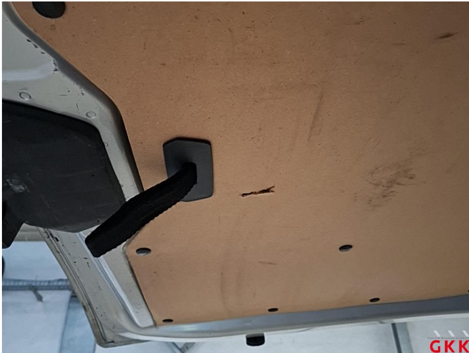
Bild 15 Heckklappe, Innenverkleidung, beschädigt, ersetzen
