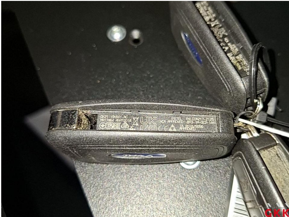
Bild 17 Hauptschlüssel, mit Fernbedienung, beschädigt, ersetzen
