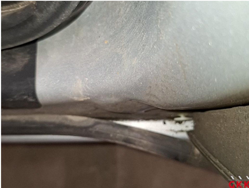
Bild 23 Tür vorne links, Dichtung -Einstieg-, lose, ersetzen
