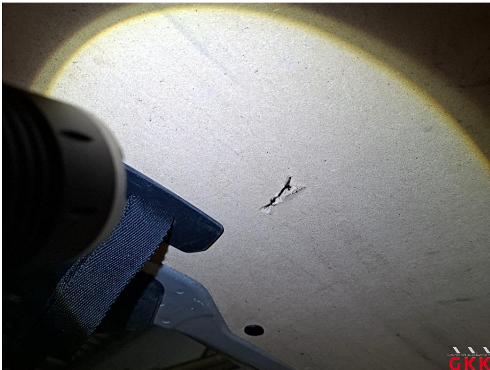
Bild 16 Heckklappe, Innenverkleidung, beschädigt, ersetzen
