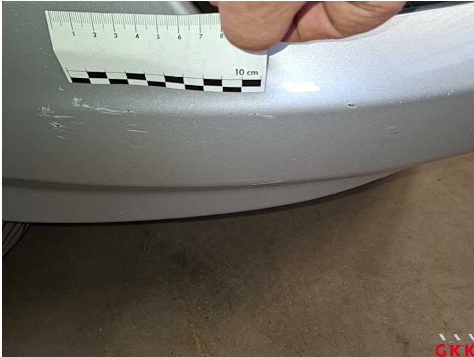
Bild 19 Stoßfänger vorne, Verkleidung unterhalb -lackiert-, verkratzt, lackieren
