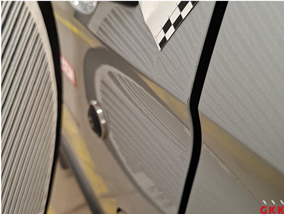
Bild 25 Tür vorne links, beschädigt, instand setzen - lackieren
