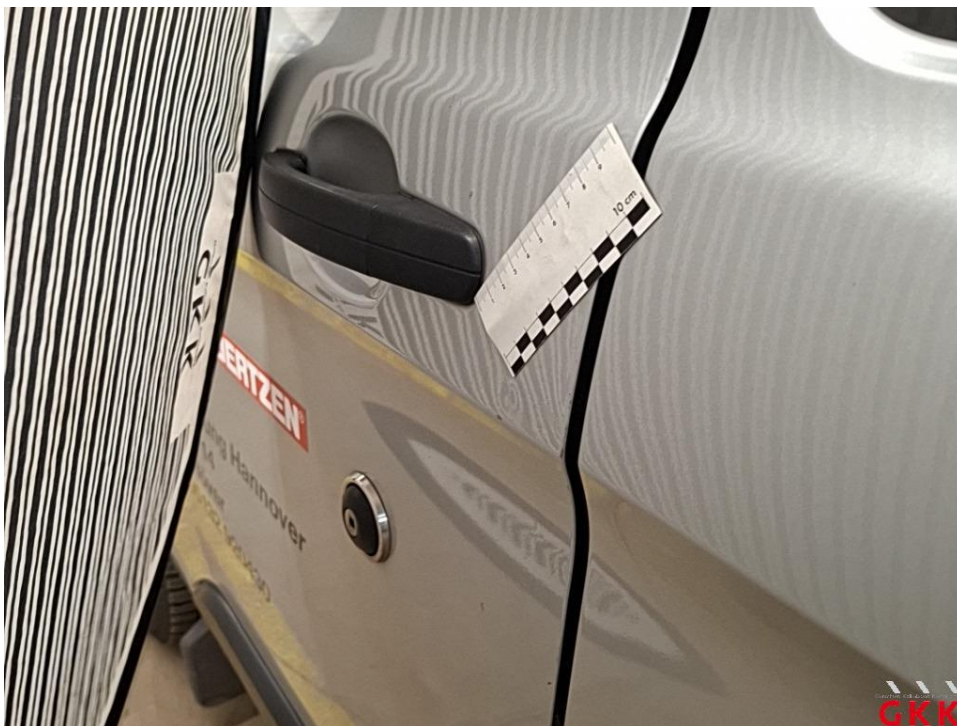
Bild 24 Tür vorne links, beschädigt, instand setzen - lackieren
