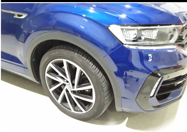
Beschädigung #7: Rad/Reifen: Leichtmetallfelge vorn rechts (Materialabrieb) - verkratzt / verschürft - erneuern
