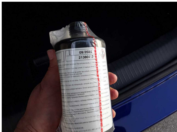
Beschädigung #1: Ausrüstung: Tirefit Füllmittel - abgelaufen - erneuern
