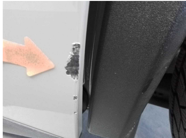
Beschädigung #1: Tür hinten links: Zierleiste unten - verkrat... verschürft - erneuern
