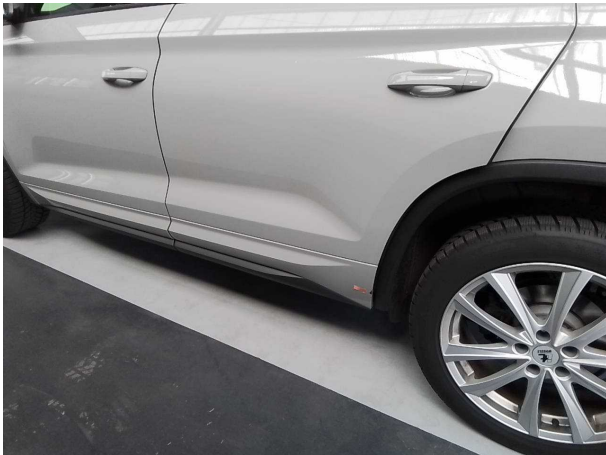
Beschädigung #1: Tür hinten links: Zierleiste unten - verkratzt / verschürft - erneuern
