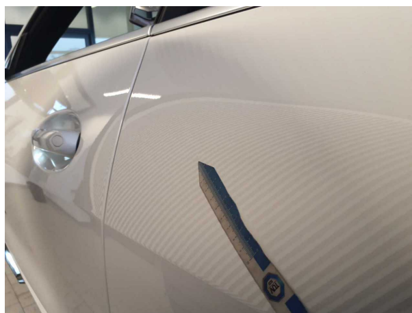
Gebrauchsspur 3: Seitenwand links: Seitenwand (Vorschaden) - Delle(n)
