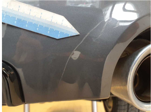
Beschädigung 1: Stossfänger hinten: Spoiler - Kratzer
