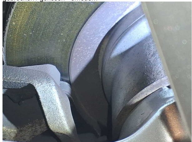
Beschädigung 6: Bremsanlage: Bremsscheiben und Beläge hinten - verschlissen - erneuern
