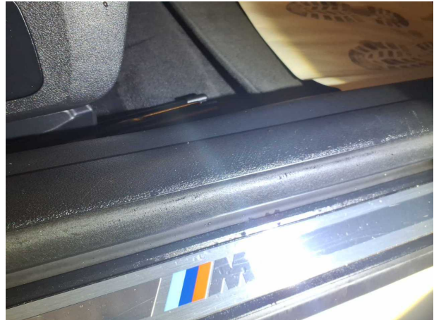
Beschädigung 5: Karosserie: Türdichtung vorn links - gebrochen / gerissen - erneuern
