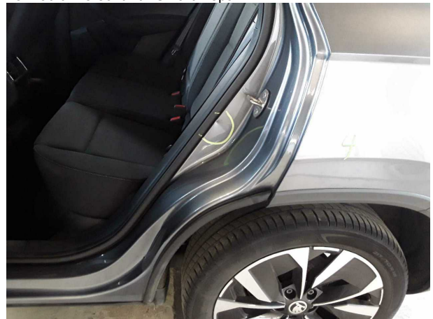
Beschädigung #4: Seitenwand links: Einstieg - Delle / Lackschaden - instandsetzen und lackieren
