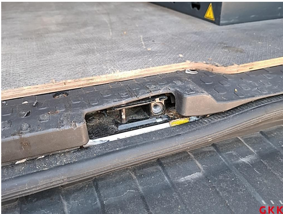
Bild 42. Ladekante, Abdeckung, beschädigt, ersetzen
