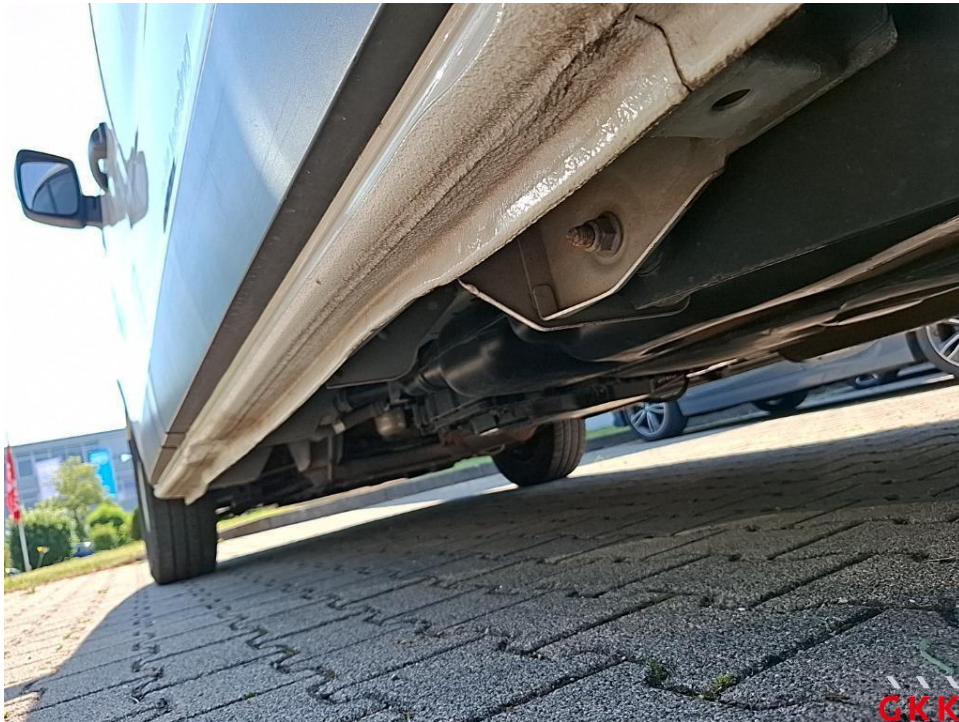
Bild 36. Schweller links, beschädigt, instand setzen - lackieren
