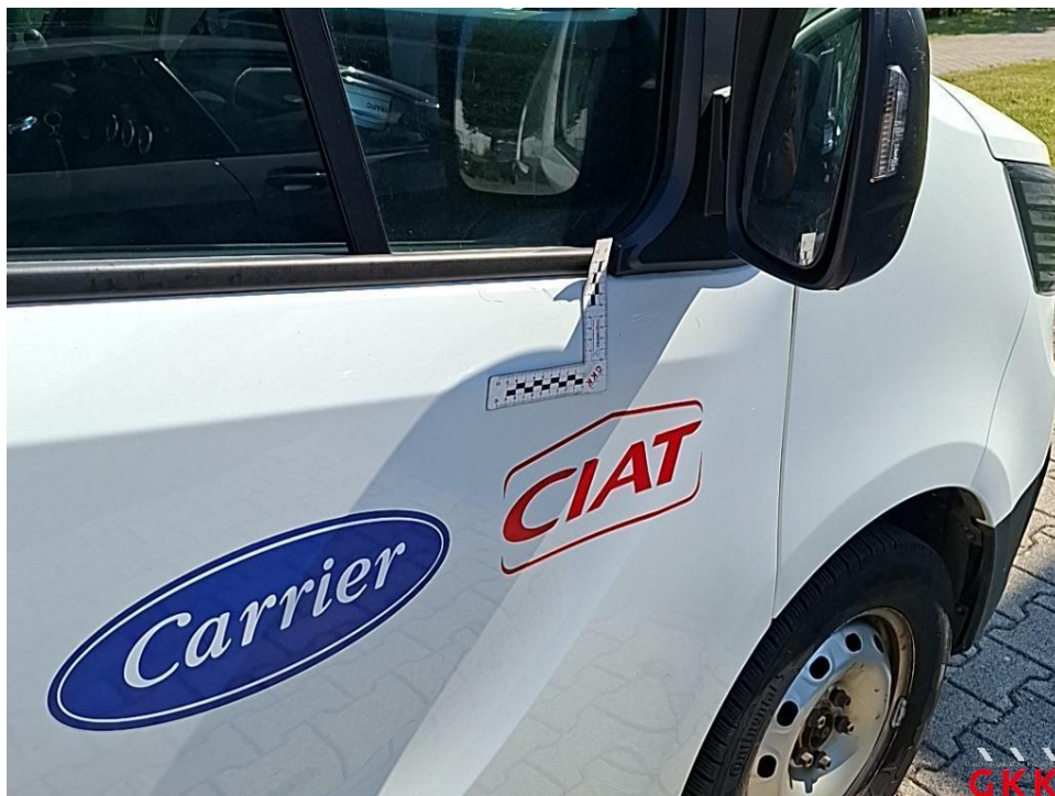
Bild 29. Tür vorne rechts, bis 3 Dellen / Bauteil, instand setzen - lackieren
