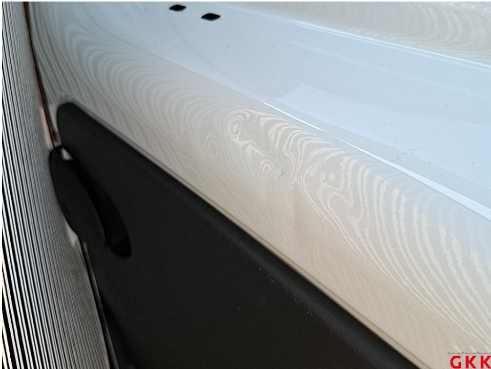
Bild 40. Hecktür rechts, innen, beschädigt, instand setzen - lackieren
