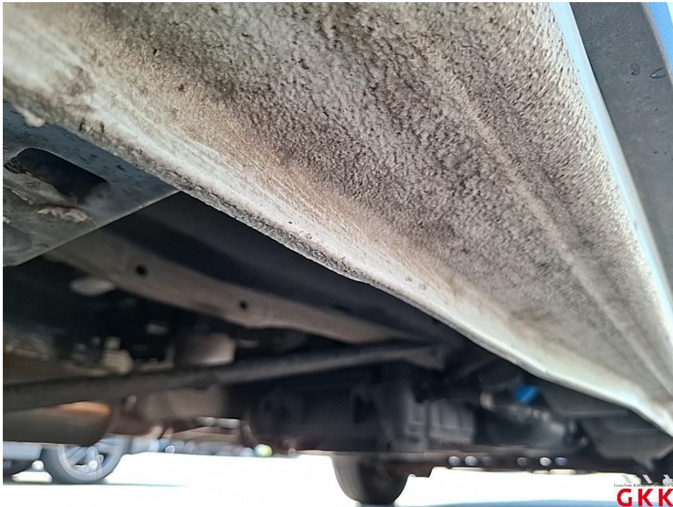
Bild 38. Schweller links, beschädigt, instand setzen - lackieren
