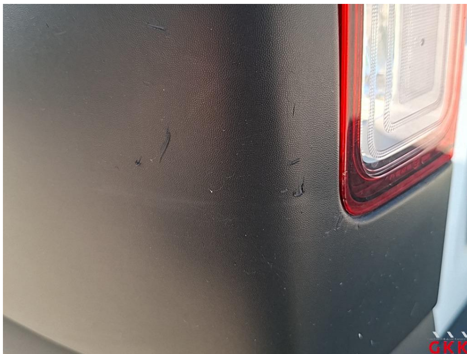
Bild 18. Stoßfänger hinten, Ecke links -unlackiert-, verkratzt, ersetzen
