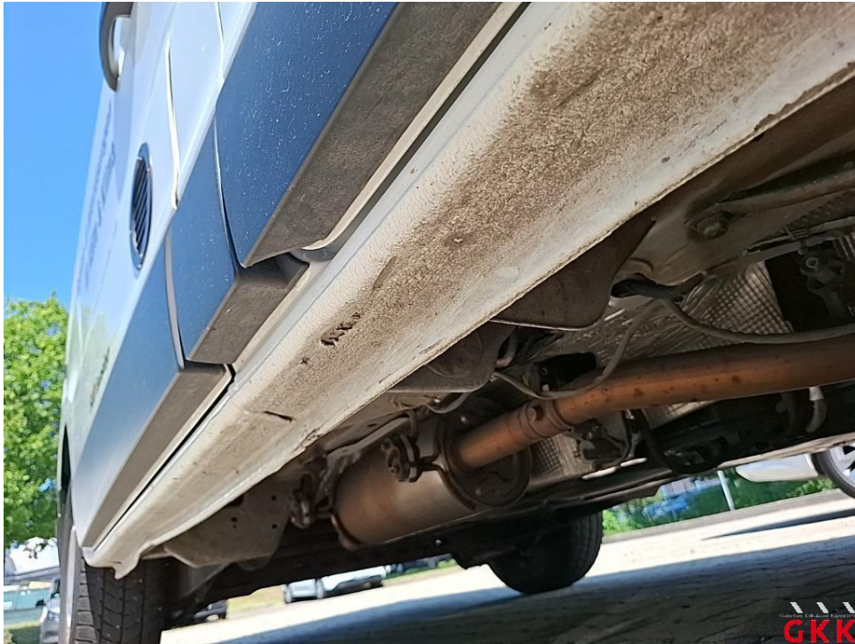
Bild 35. Schweller rechts, beschädigt, instand setzen - lackieren
