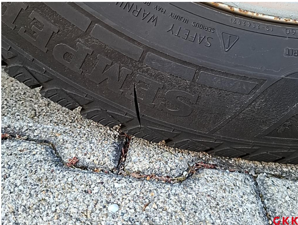
Bild 22. Reifen, hinten links, beschädigt, ersetzen
