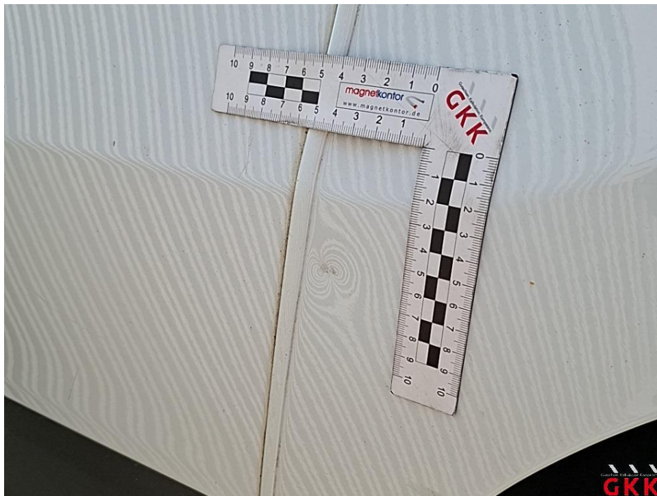
Bild 20. Seitenwand links, hinten, beschädigt, instand setzen - lackieren
