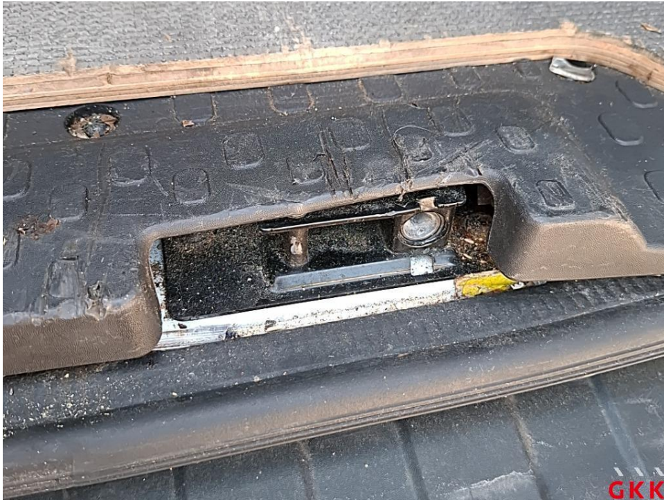
Bild 43. Ladekante, Abdeckung, beschädigt, ersetzen
