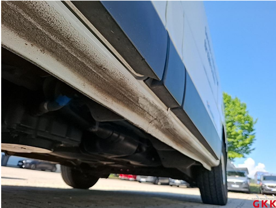
Bild 37. Schweller links, beschädigt, instand setzen - lackieren
