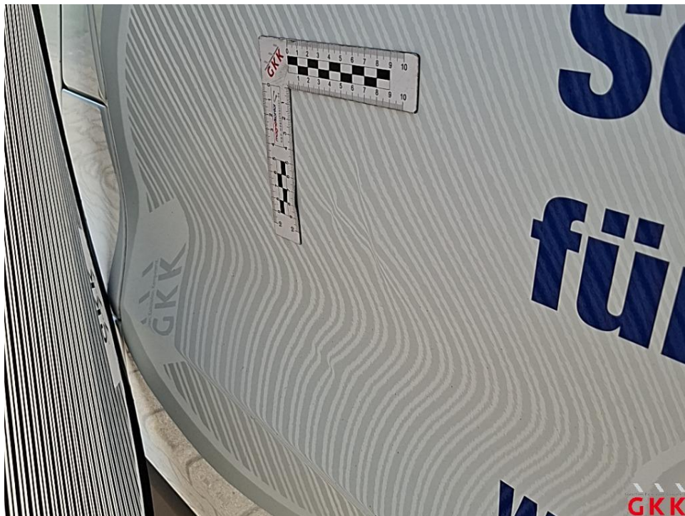
Bild 24. Seitenwand links, vorne, beschädigt, instand setzen - lackieren
