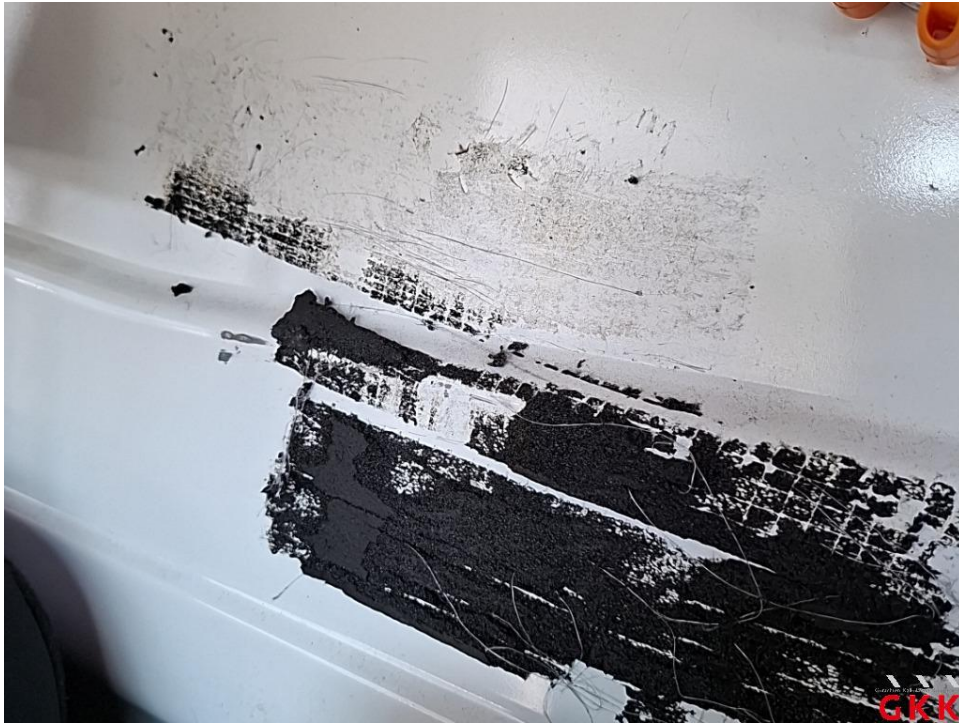
Bild 45. Trennwand, oberhalb, verkratzt, Smartrepair
