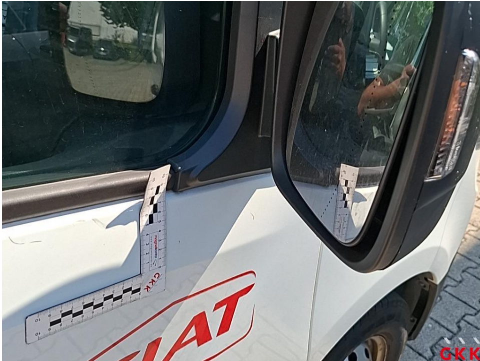
Bild 31. Spiegelgehäuse rechts, Halter, beschädigt, ersetzen
