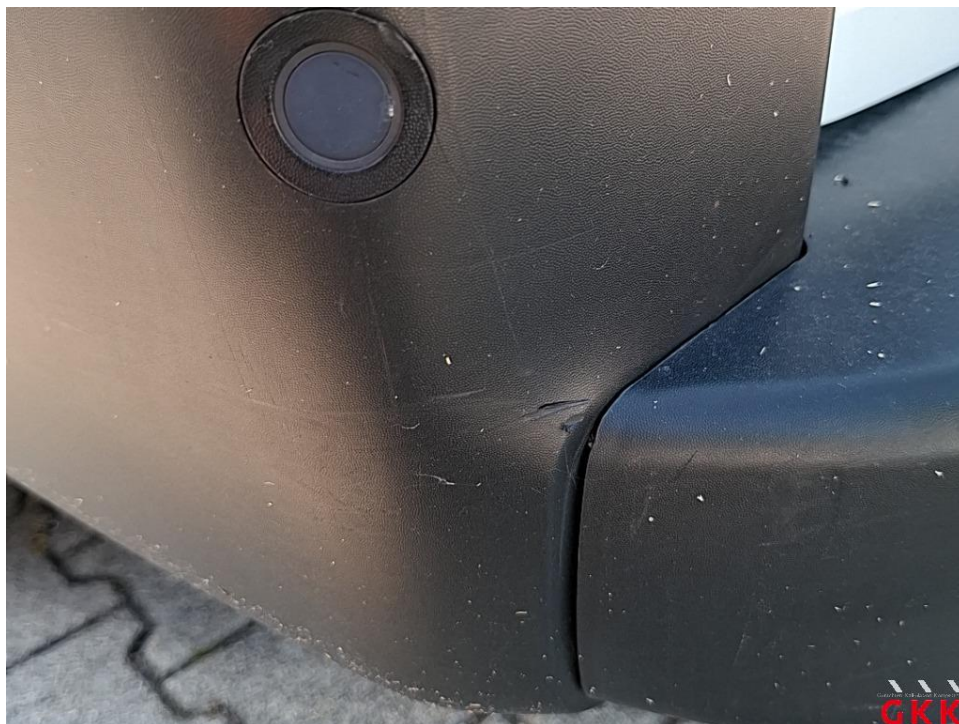
Bild 17. Stoßfänger hinten, Ecke links -unlackiert-, verkratzt, ersetzen
