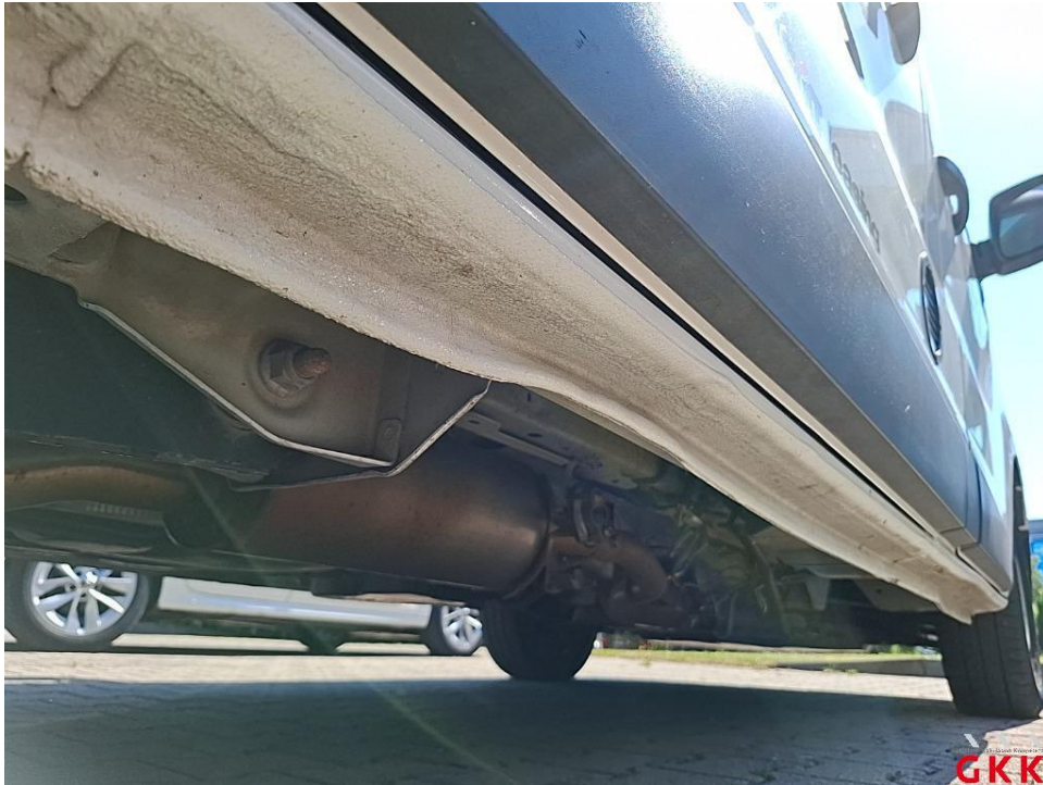
Bild 33. Schweller rechts, beschädigt, instand setzen - lackieren
