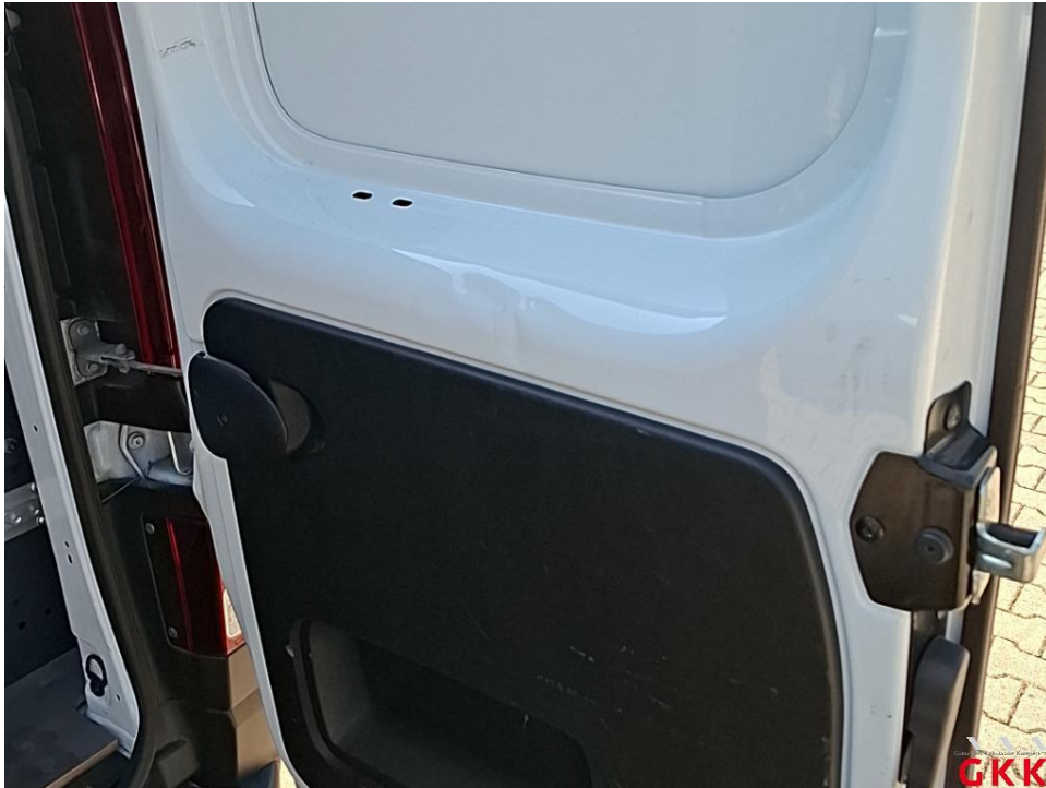
Bild 39. Hecktür rechts, innen, beschädigt, instand setzen - lackieren
