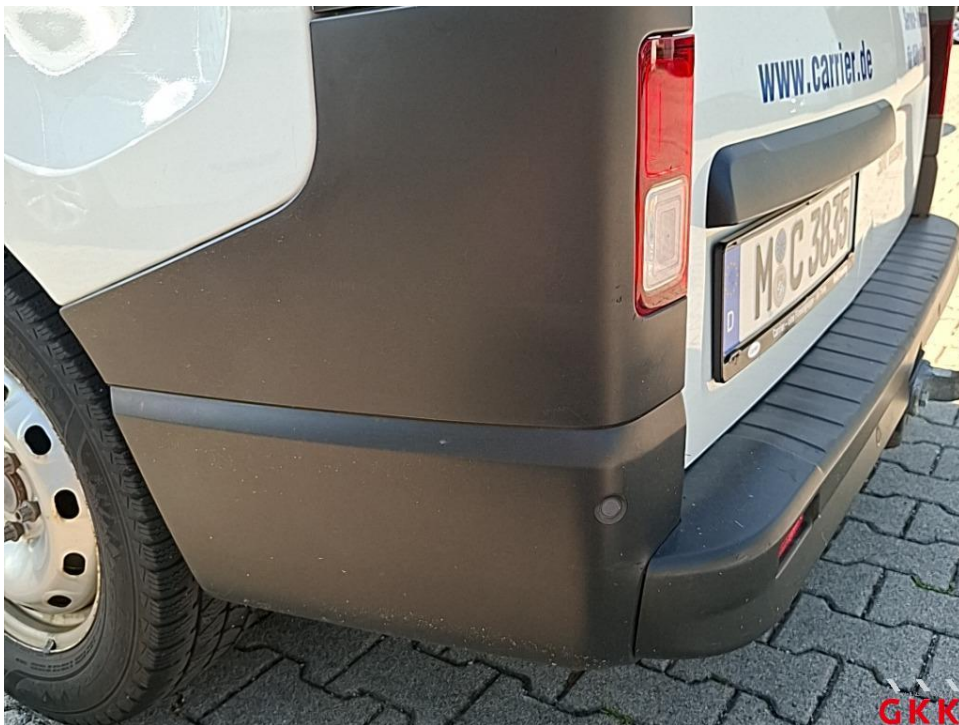
Bild 16. Stoßfänger hinten, Ecke links -unlackiert-, verkratzt, ersetzen
