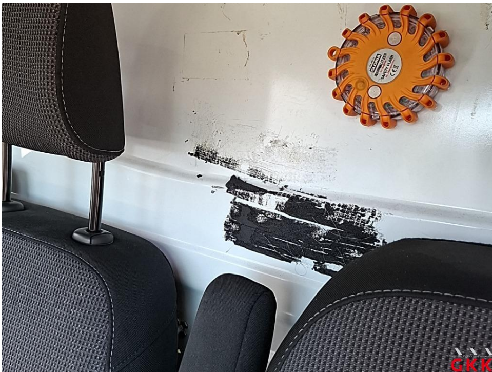
Bild 44. Trennwand, oberhalb, verkratzt, Smartrepair
