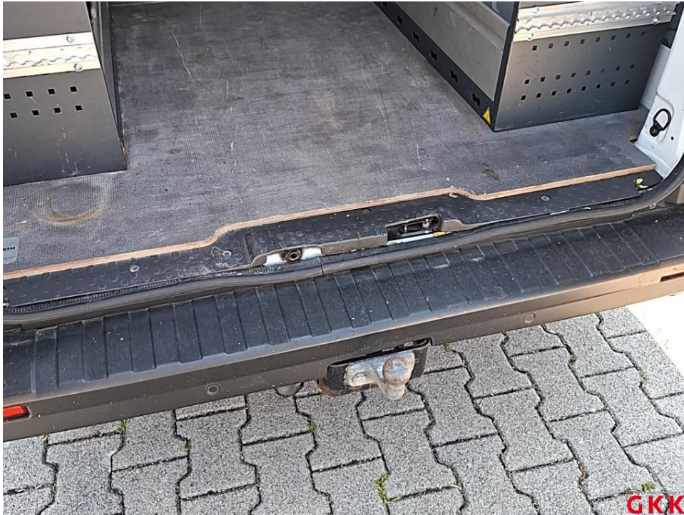
Bild 41. Ladekante, Abdeckung, beschädigt, ersetzen
