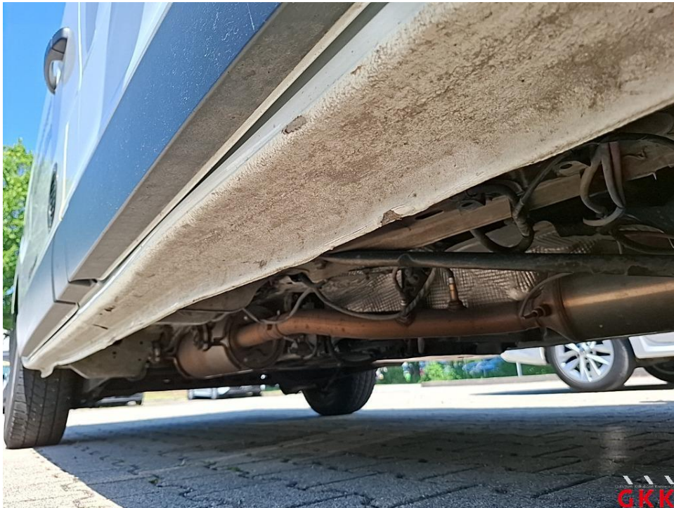
Bild 34. Schweller rechts, beschädigt, instand setzen - lackieren
