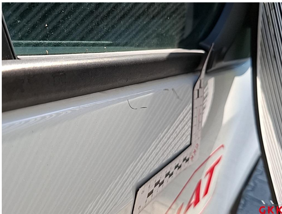
Bild 30. Tür vorne rechts, bis 3 Dellen / Bauteil, instand setzen - lackieren
