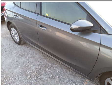
Puerta / Delantero Derecho / Abolladura
