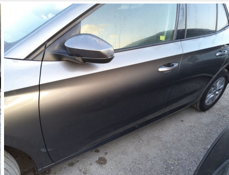
Puerta / Delantero Izquierdo / Abolladura
