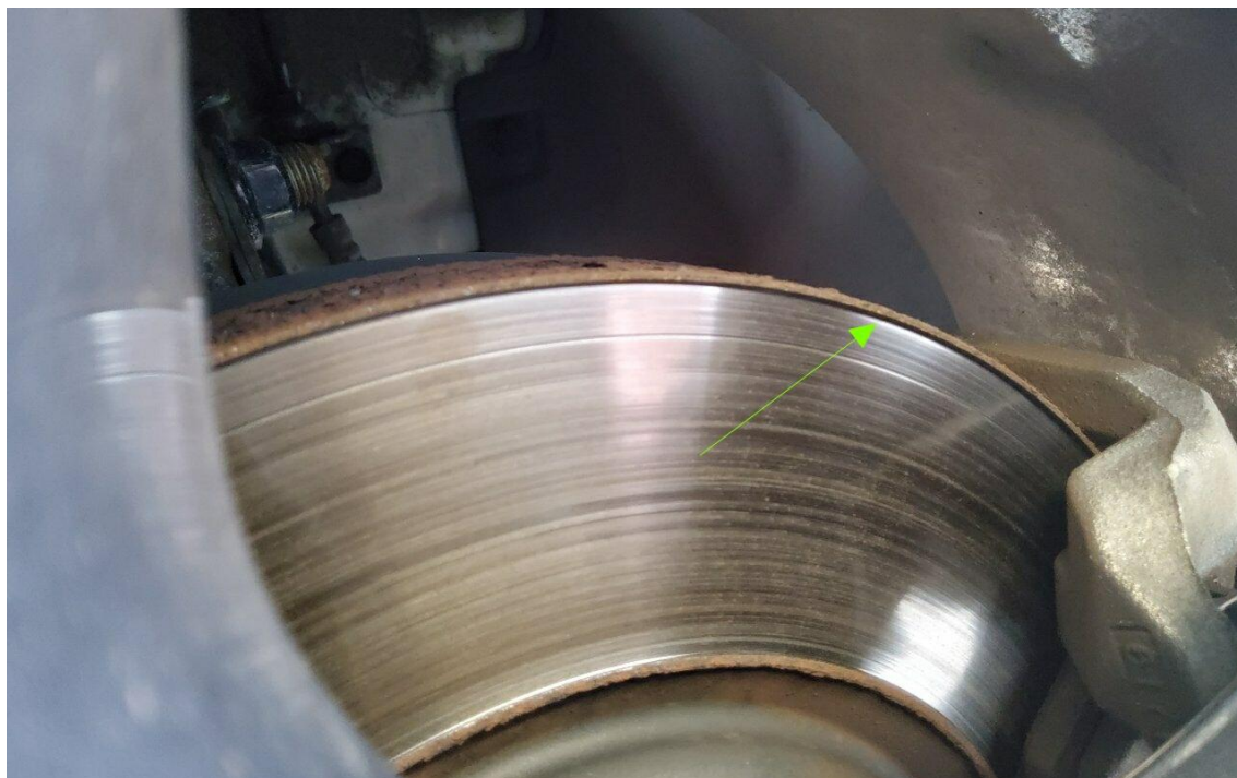
Bild 15 : T- Bremsscheiben Vorderachse eingelaufen
