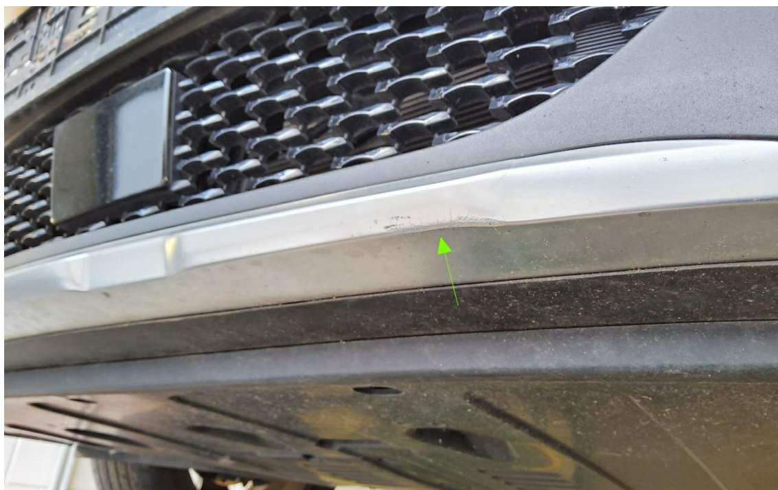
Bild 16 : Zierblende Stoßfänger vorne angefahren
