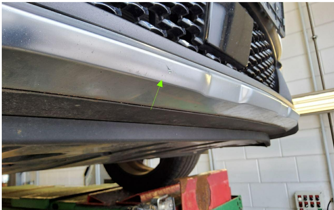
Bild 17 : Zierblende Stoßfänger vorne angefahren
