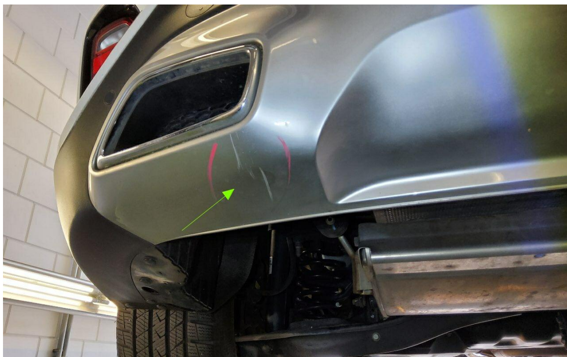
Bild 18 : Zierblende Stoßfänger hinten verschrammt
