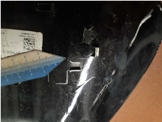
Damage 5: Fuel system: Tank flap (Mehrkosten können entstehen) - Broken / torn - Replace
