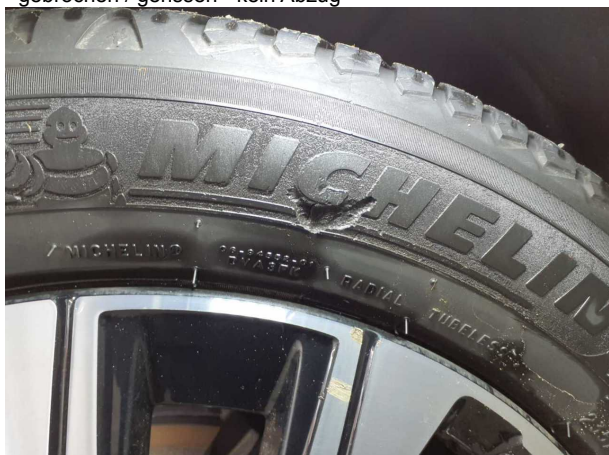
Beschädigung #1: Rad/Reifen: Reifen hinten rechts (Kundeneigentum)... - gebrochen / gerissen - kein Abzug
