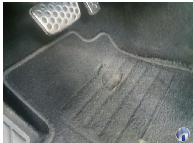
13. Fußraum Innenraum links vorne Loch - Erneuern
