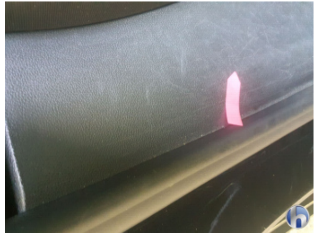
12. Verkleidung Gebrauchsspuren - Ohne Reparatur
