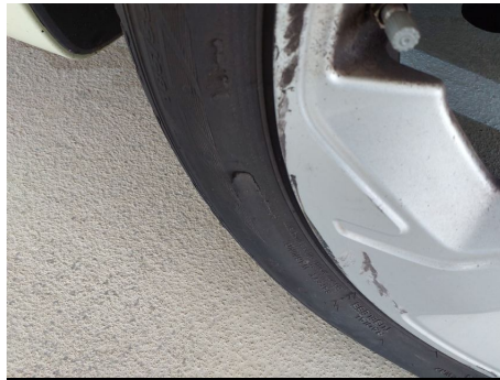
Reifen / Vorne Rechts / Abgewetzt
