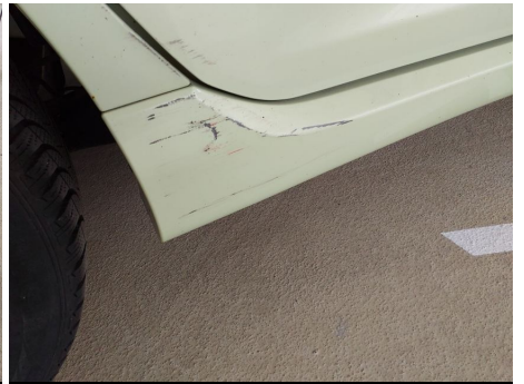
Schwellerabdeckung / Rechts / Kratzer
