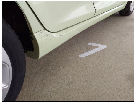
Schwellerabdeckung / Rechts / Kratzer
