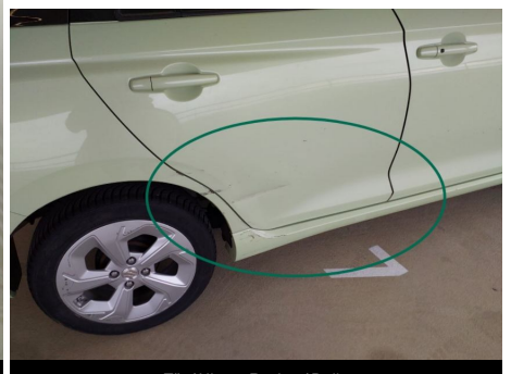
Tür / Hinten Rechts / Delle
