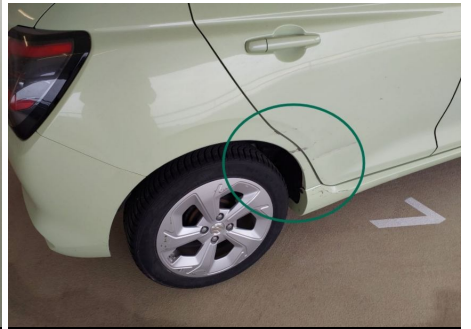
Kotflügel / Hinten Rechts / Delle
