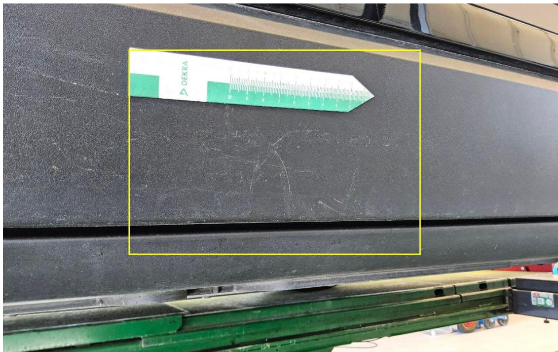
Bild 9 : Türzierleiste hinten links verschrammt
