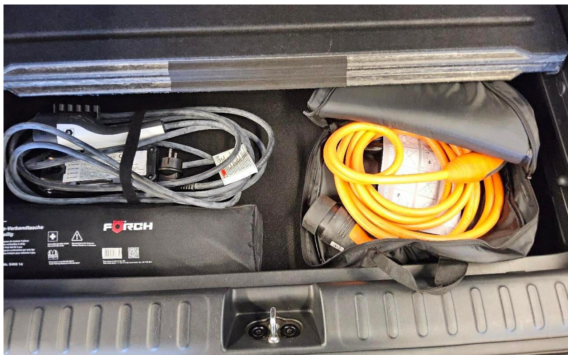
Bild 6 : Ladekabel beim E-Fahrzeug
