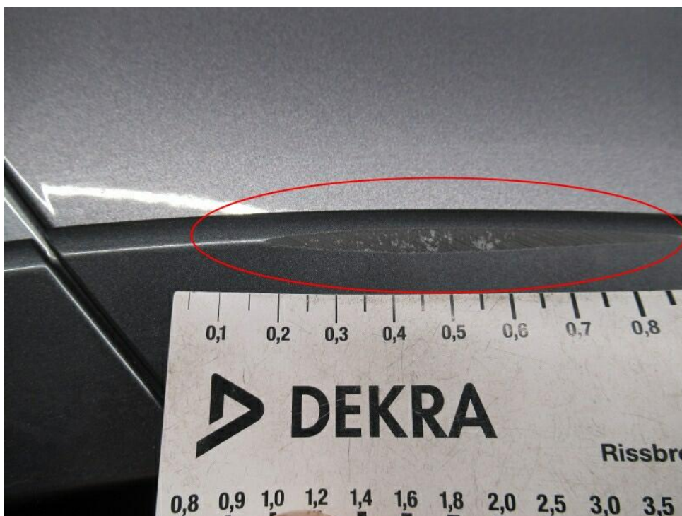
Bild 20 : Radlaufblende vorne links, verschrammt (Materialabtrag)
