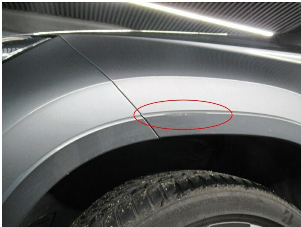
Bild 19 : Radlaufblende vorne links, verschrammt (Materialabtrag)
