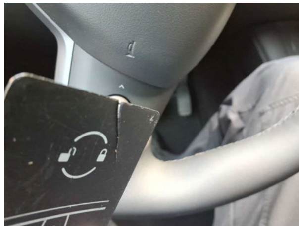
Beschädigung #1: Ausrüstung: Fahrzeugschlüssel - gebrochen / gerissen - erneuern
