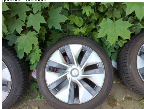
Beschädigung #2: 2.Radsatz: 3 Radblenden - gebrochen / gerissen - erneuern
