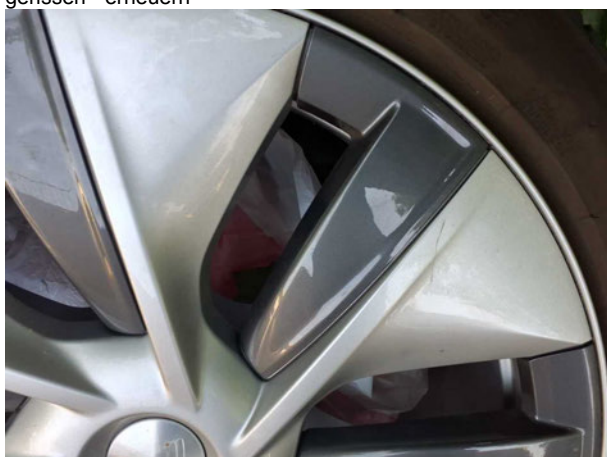
Beschädigung #2: 2.Radsatz: 3 Radblenden - gebrochen / gerissen - erneuern
