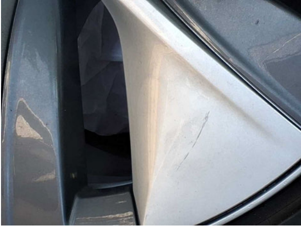
Beschädigung #2: 2.Radsatz: 3 Radblenden - gebrochen / gerissen - erneuern
