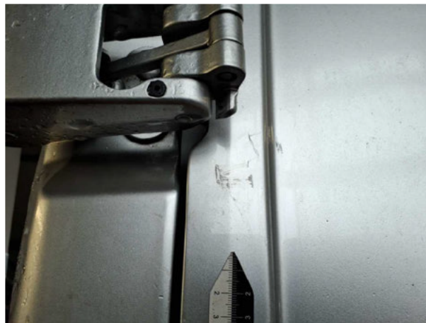
Beschädigung #1: Heckklappe/-tür: Hecktür links - Delle / Lackschaden - instandsetzen und lackieren
