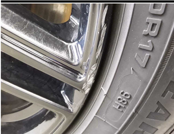
Damage #7: Wheel / tyres: Alloy rim - front right side (Sicherheitsrelevante Beschädigung) - Scratched - Replace
