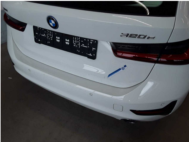
Beschädigung #5: Heckklappe/-tür: Heckklappe - Kratzer - lackieren
