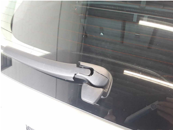
Beschädigung #1: Scheibenreinigung: Scheibenwischerarm hint... (Deckel) - gebrochen / gerissen - erneuern
