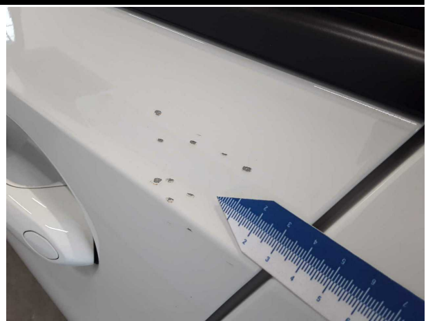
Beschädigung #4: Tür vorn links: Tür - Kratzer - lackieren
