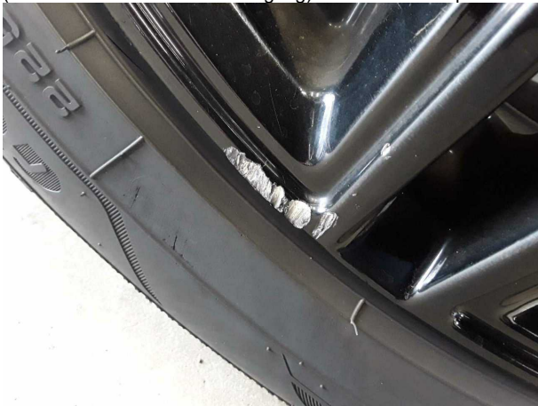
Damage #8: Wheel / tyres: Alloy rim - rear right side (Sicherheitsrelevante Beschädigung) - Scratched - Replace
