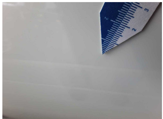
Beschädigung #3: Tür hinten rechts: Tür - Kratzer - lackieren
