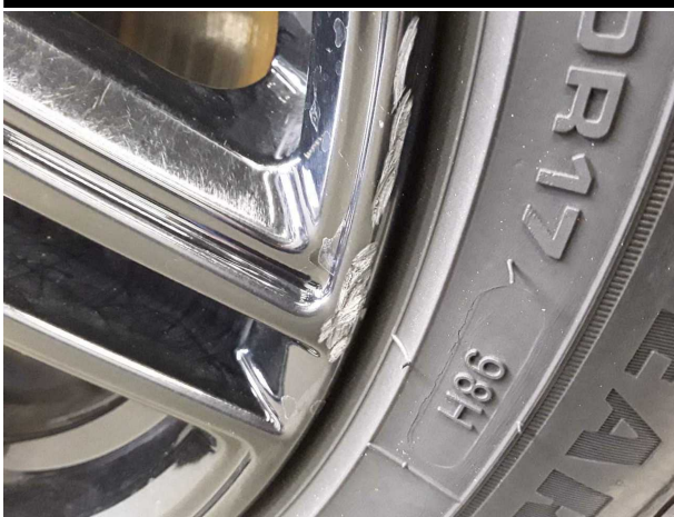
Beschädigung #7: Rad/Reifen: Leichtmetallfelge vorn rechts (Sicherheitsrelevante Beschädigung) - verkratzt / verschürft -
