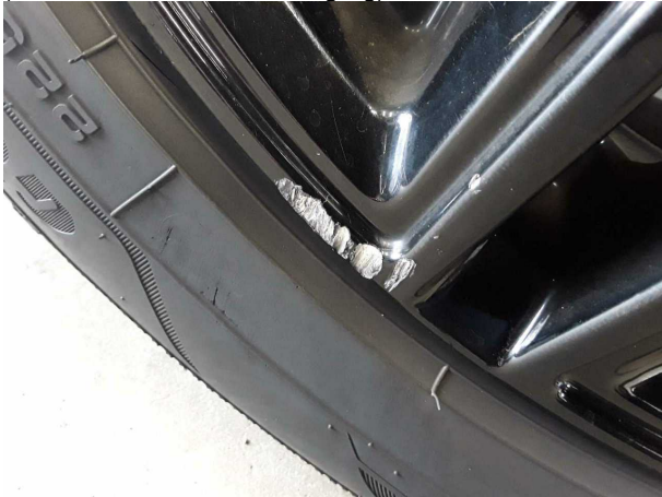
Beschädigung #8: Rad/Reifen: Leichtmetallfelge hinten rechts (Sicherheitsrelevante Beschädigung) - verkratzt / verschürft -
