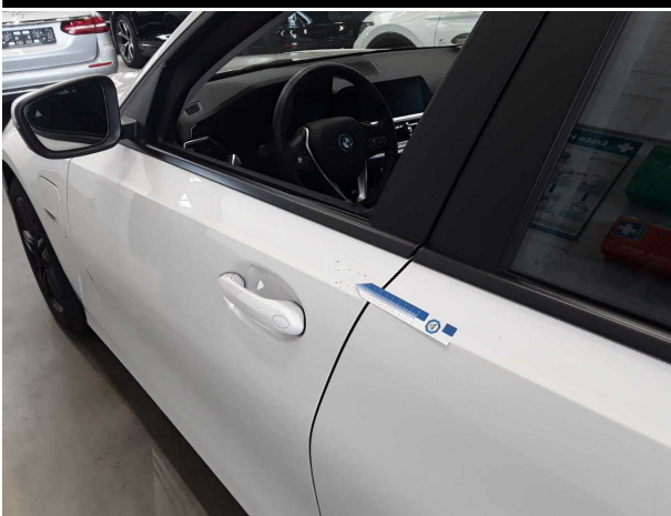
Damage #4: Door - front left side: Door - Scratch(es) - Paint
