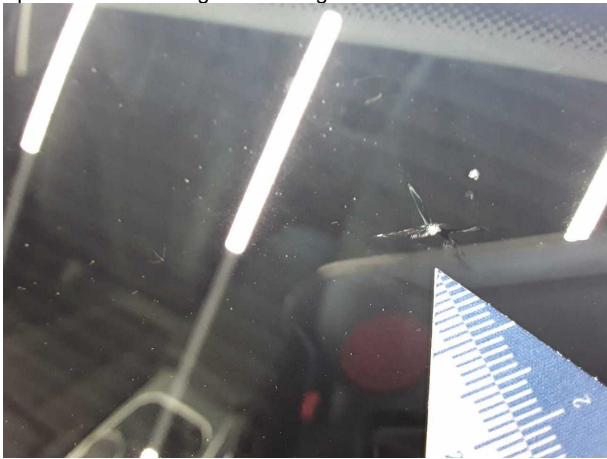
Beschädigung #10: Verglasung: Frontscheibe mit Spurhalteassistent - gebrochen / gerissen - erneuern
