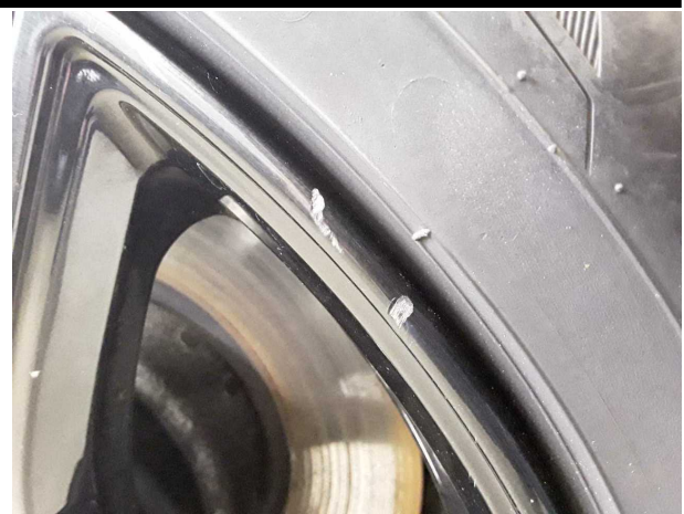
Beschädigung #7: Rad/Reifen: Leichtmetallfelge vorn rechts (Sicherheitsrelevante Beschädigung) - verkratzt / verschürft -
