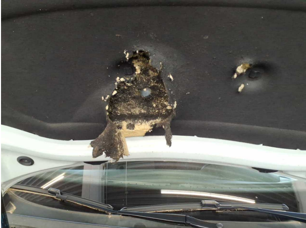
Beschädigung #1: Motorhaube: Dämmmatte - Löcher - erneuern
