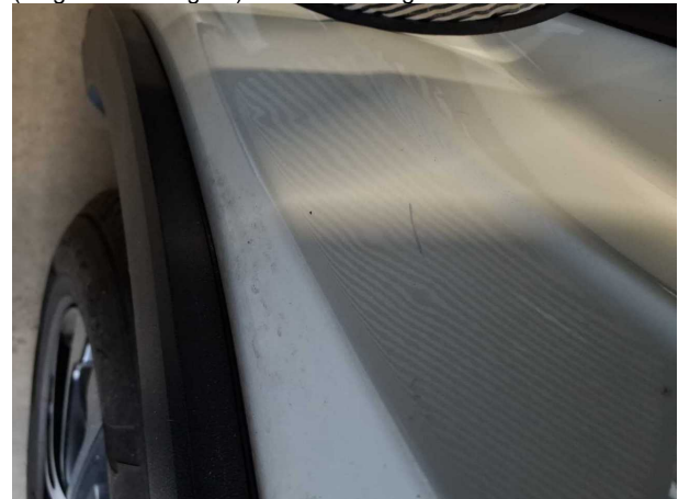
Beschädigung #3: Seitenwand links: Einstieg - Delle / Lackschaden - instandsetzen und lackieren
