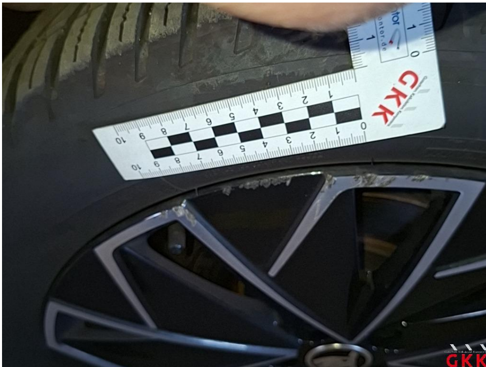
Bild 18 LM-Rad, vorne rechts, Materialabtrag, ersetzen
