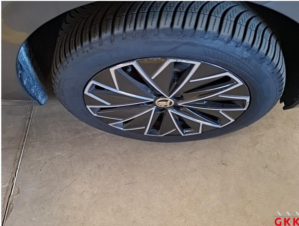
Bild 17 LM-Rad, vorne rechts, Materialabtrag, ersetzen
