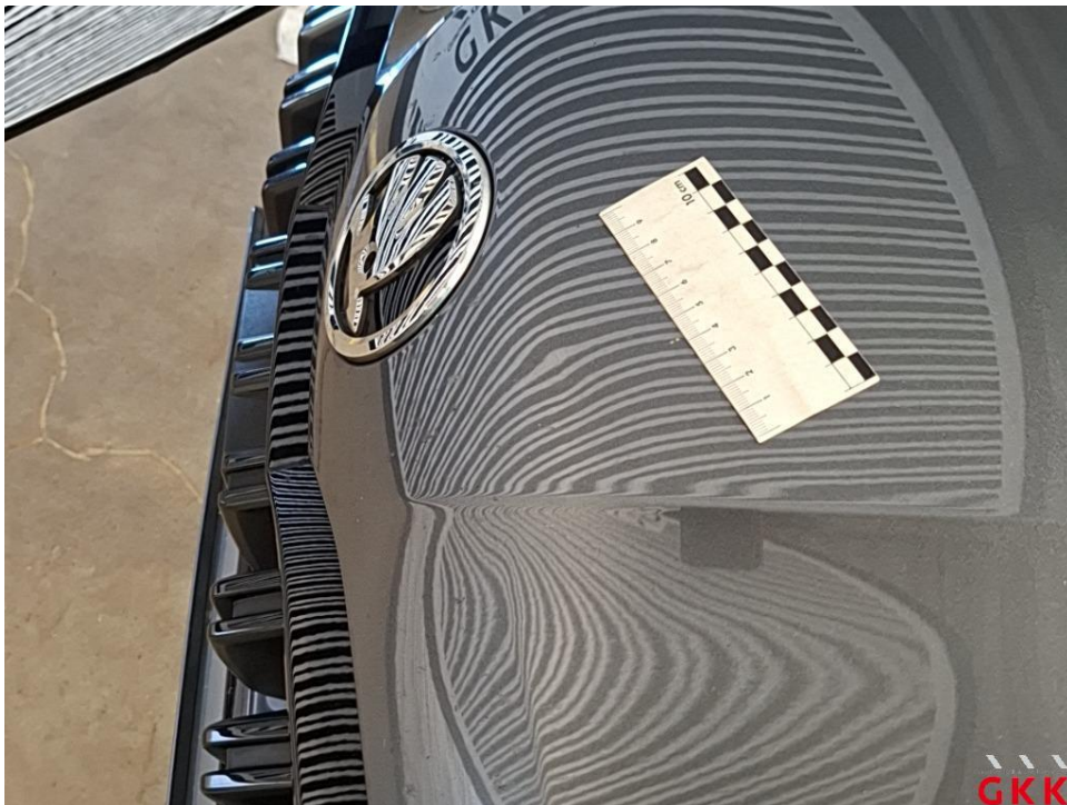
Bild 20 Motorhaube, beschädigt, kalt drücken
