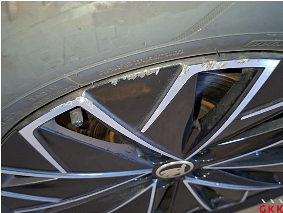
Bild 19 LM-Rad, vorne rechts, Materialabtrag, ersetzen
