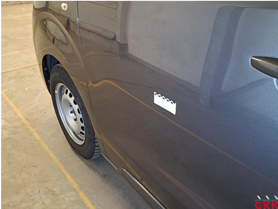
Bild 27 Tür vorne links, verkratzt, lackieren
