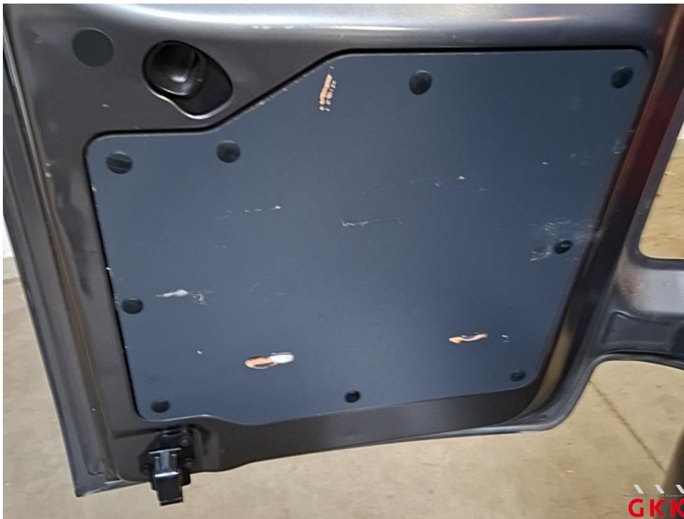
Bild 20 Hecktür links, Innenverkleidung, beschädigt, ersetzen
