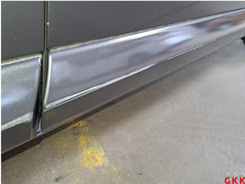
Bild 33 Tür vorne rechts, Leiste -unten-, beschädigt, ersetzen
