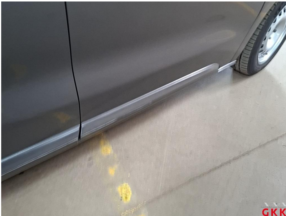
Bild 32 Tür vorne rechts, Leiste -unten-, beschädigt, ersetzen
