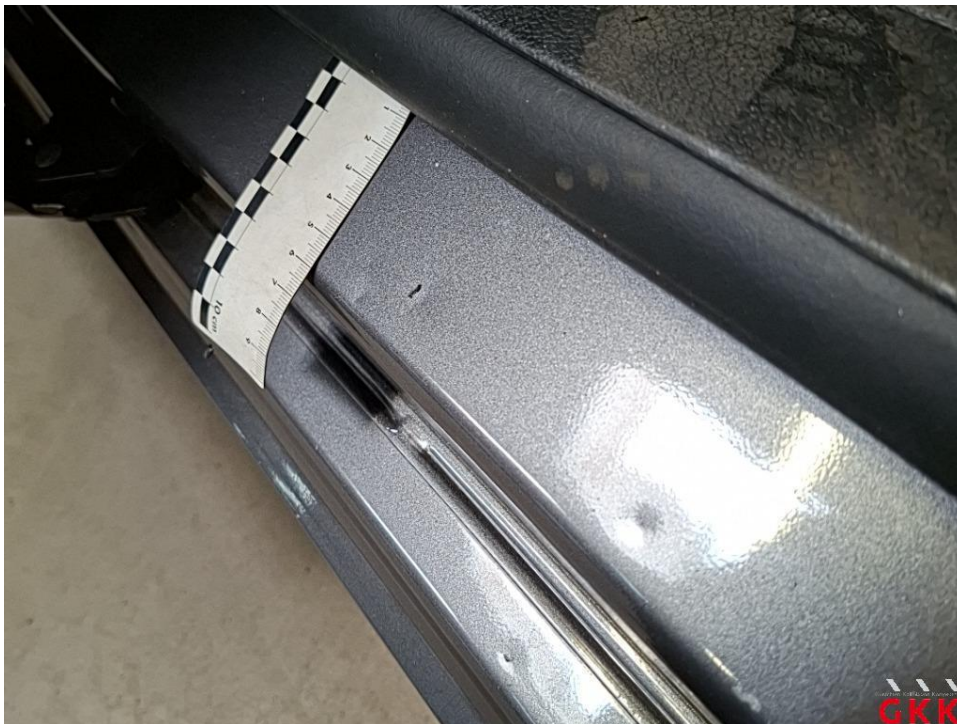
Bild 24 Schiebetür rechts, Einstieg, beschädigt, instand setzen - lackieren
