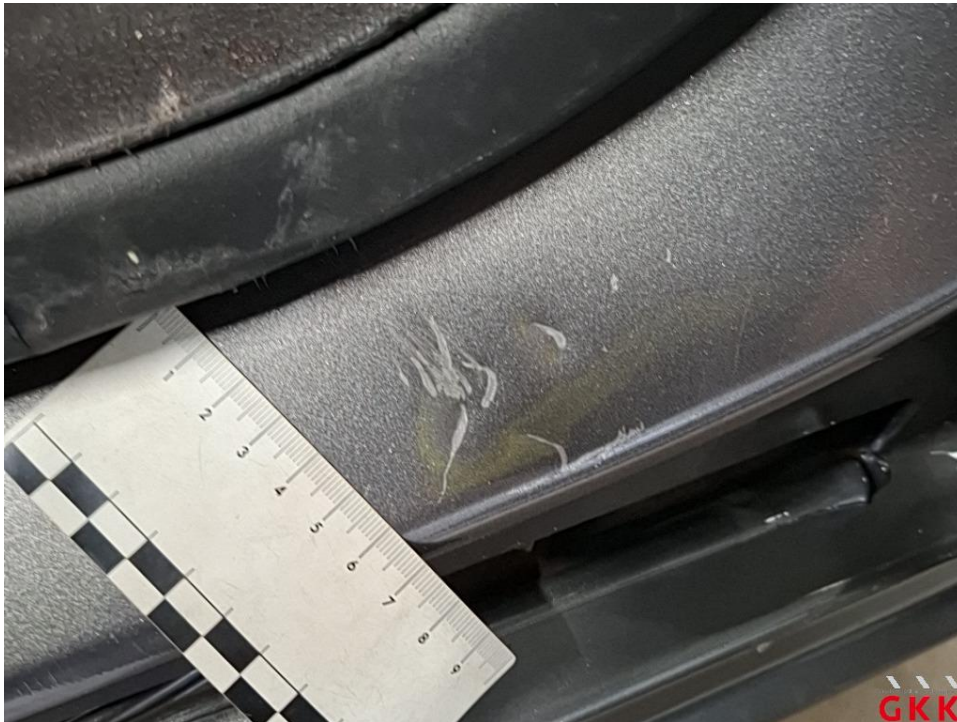
Bild 23 Schiebetür rechts, Einstieg, beschädigt, instand setzen - lackieren
