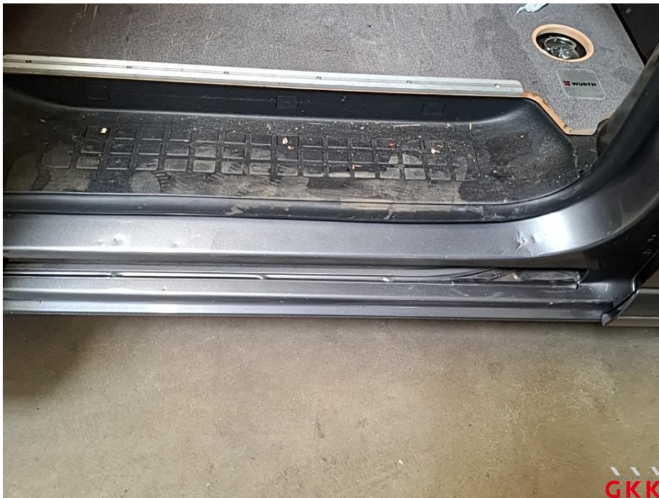
Bild 22 Schiebetür rechts, Einstieg, beschädigt, instand setzen - lackieren
