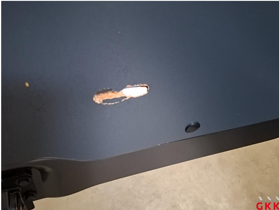
Bild 21 Hecktür links, Innenverkleidung, beschädigt, ersetzen
