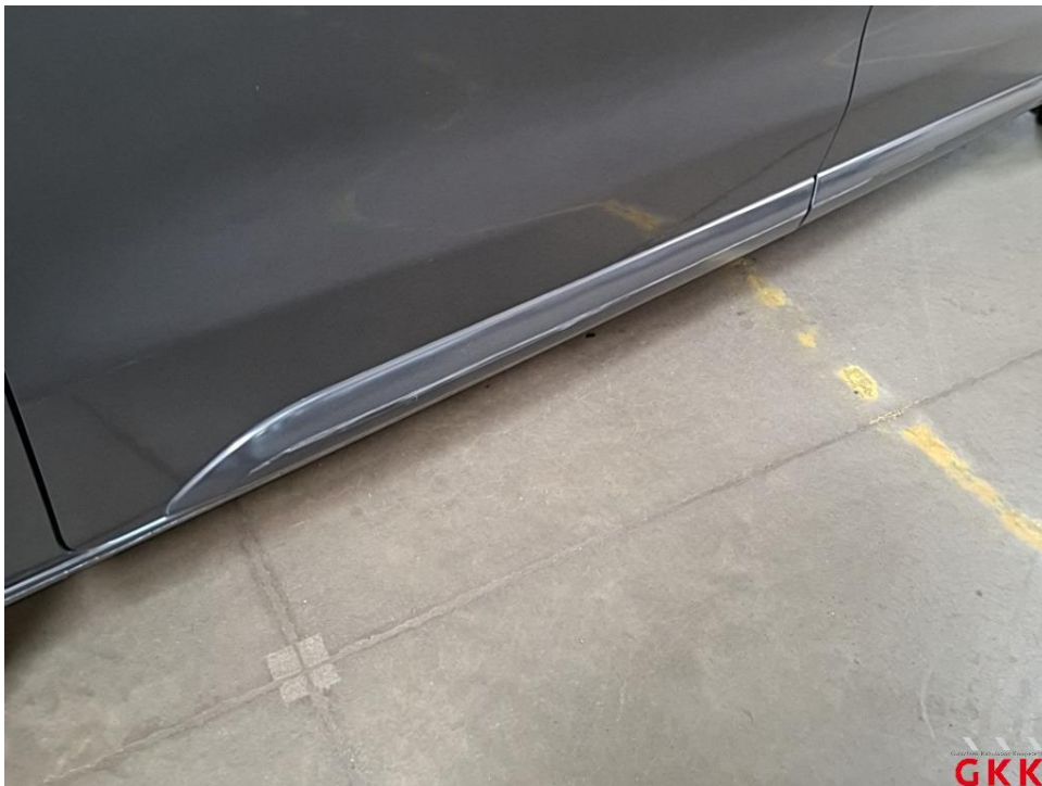
Bild 30 Schiebetür rechts, Leiste -unten-, beschädigt, ersetzen
