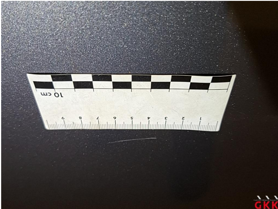
Bild 29 Tür vorne links, verkratzt, lackieren
