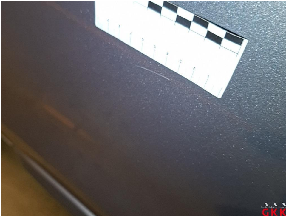
Bild 28 Tür vorne links, verkratzt, lackieren
