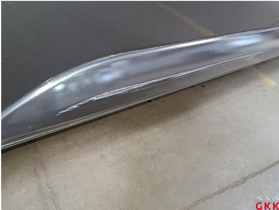
Bild 31 Schiebetür rechts, Leiste -unten-, beschädigt, ersetzen
