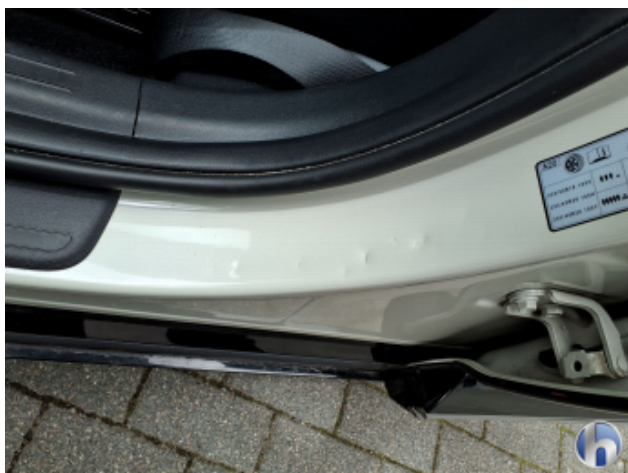
1. Schweller - Links Beschädigt - Smart Repair
