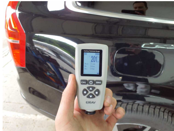
Nachlackierung 2: Seitenwand rechts
