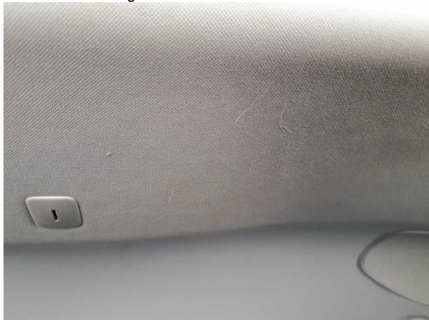
Beschädigung #2: Verkleidungen/Abdeckungen: Dachhimmel - verschmutzt - reinigen
