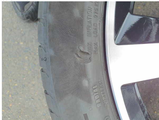
Beschädigung #18: 2.Radsatz: 2 Reifen (Sommerreifen) - beschädigt - erneuern
