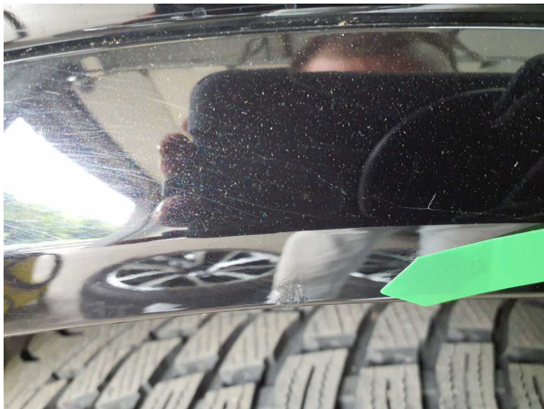
Beschädigung #4: Seitenwand rechts: Radhausverbreiterung - Kratz... - Smart Repair
