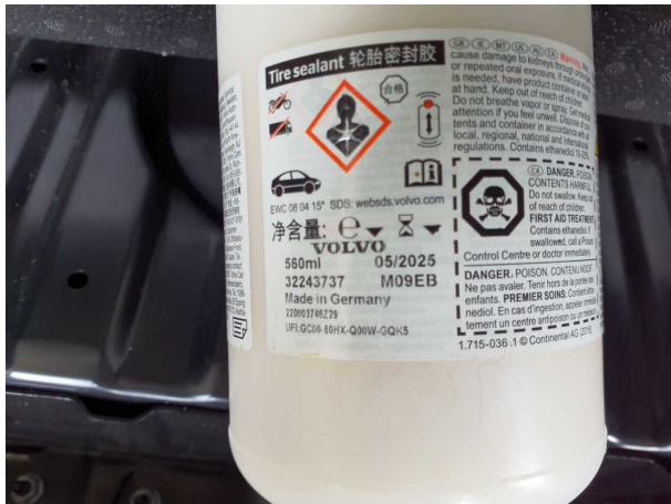
Beschädigung #1: Ausrüstung: Tirefit Füllmittel - abgelaufen - erneuern
