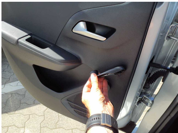
Beschädigung #1: Tür hinten links: Fensterheber (Kurbel) - gebrochen / gerissen - erneuern
