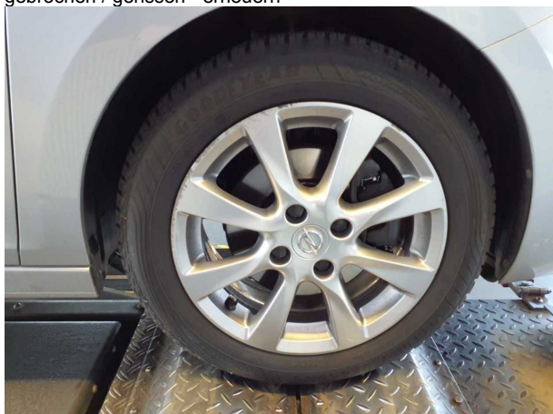
Beschädigung #2: Rad/Reifen: Leichtmetallfelge vorn rechts - verkratzt / verschürft - erneuern
