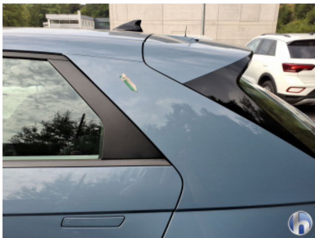
4. Seitenwand - Hinten - Links Kratzer - Smart Repair
