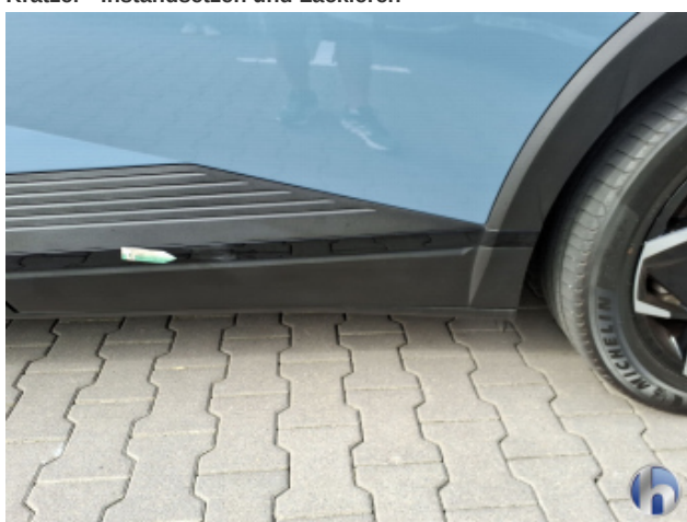
9. Türleiste Beschädigt - Erneuern
