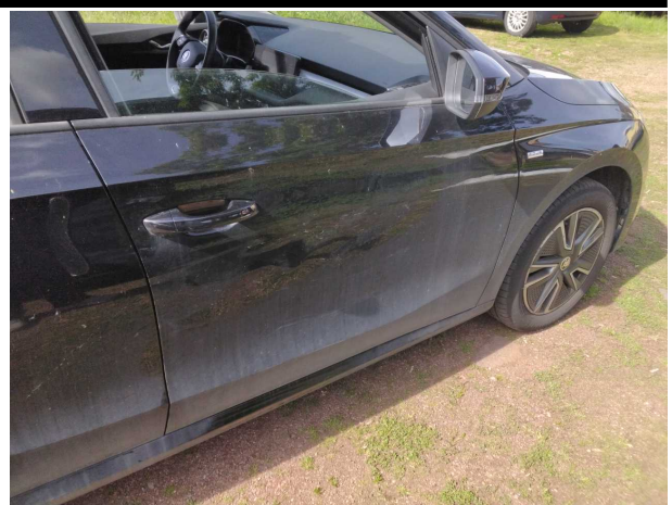
Beschädigung #10: Tür vorn rechts: Tür (Schadenausweitung möglich) - Delle / Lackschaden - instandsetzen und lackieren
