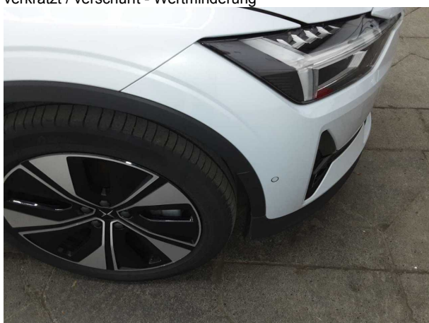
Beschädigung #3: Kotflügel rechts: Radhausverbreiterung - verkratzt / verschürft - erneuern
