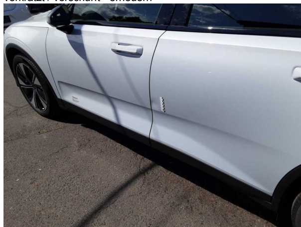
Beschädigung #6: Tür hinten links: Tür - Delle(n) - instandsetzen und lackieren
