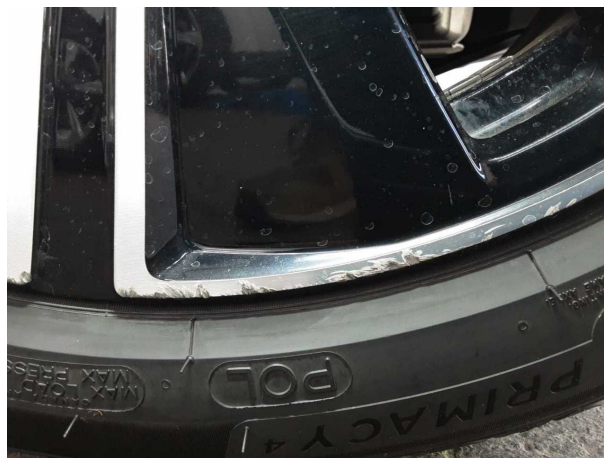
Beschädigung #4: Rad/Reifen: Leichtmetallfelge hinten links - verkratzt / verschürft - erneuern
