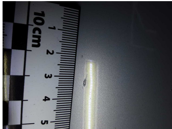
Beschädigung #1: Motorhaube: Motorhaube - Steinschlag - auslegen / polieren
