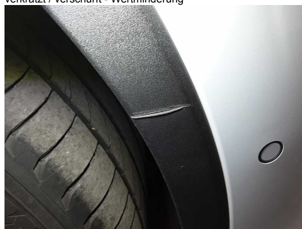
Beschädigung #3: Kotflügel rechts: Radhausverbreiterung - verkratzt / verschürft - erneuern
