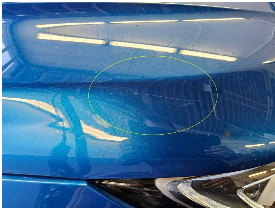
Bild 6 : Motorhaube Kratzer und Lackabplatzer
