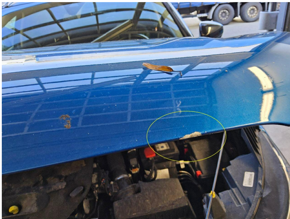
Bild 7 : Motorhaube Kratzer und Lackabplatzer
