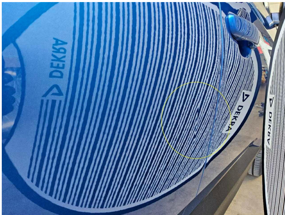
Bild 9 : Türe hinten rechts eingedrückt
