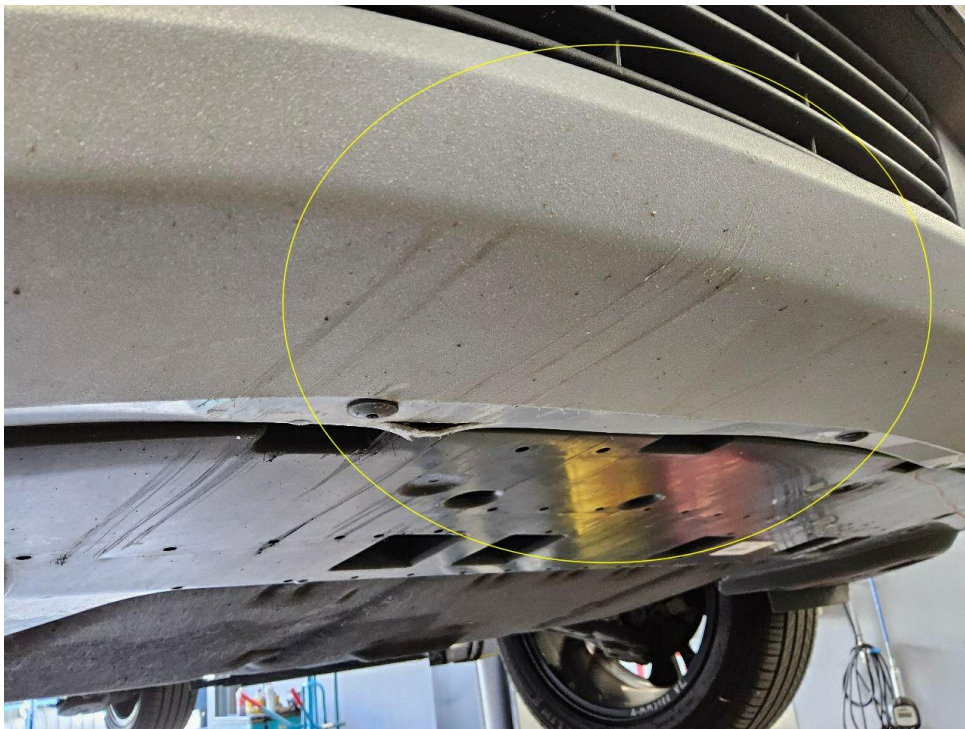
Bild 20 : Stoßfängerblende vorne Spoilerlippe verschrammt
