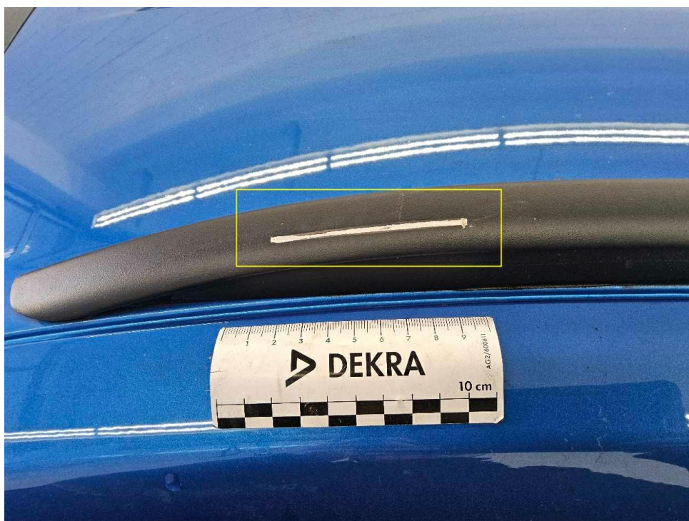
Bild 18 : Dachreling links, zerkratzt
