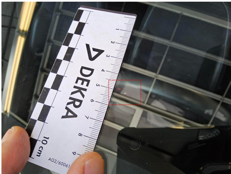
Bild 14 : Windschutzscheibe, Steinschlag im Fahrersichtfeld
