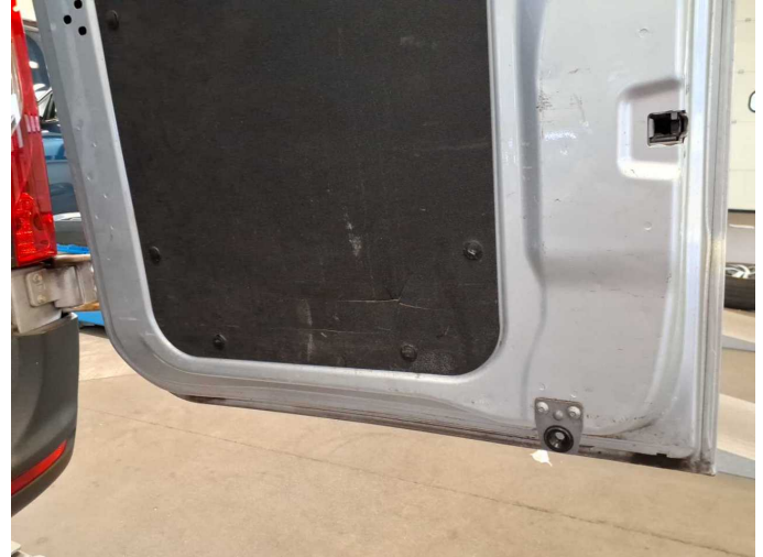
Damage 3: Boot lid / rear door: Rear door - right side (Verkleidung innen) - Broken / torn - Replace
