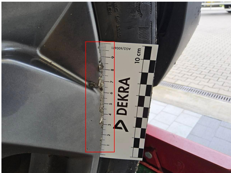
Bild 18 : Felge vorne rechts beschädigt
