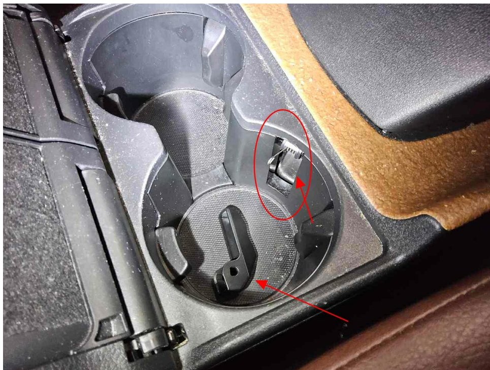
Bild 15 : Mittelkonsole Becherhalter defekt
