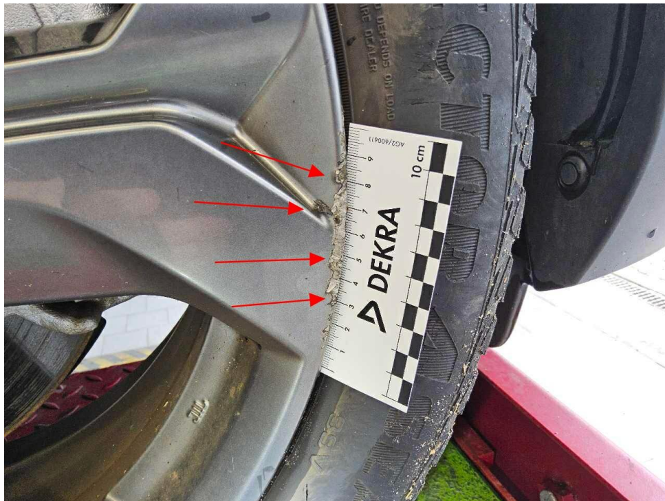
Bild 17 : Felge vorne rechts beschädigt
