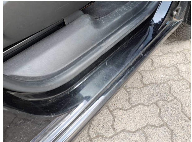
Beschädigung #9: Schweller rechts: Einstieg - Kratzer - lackieren
