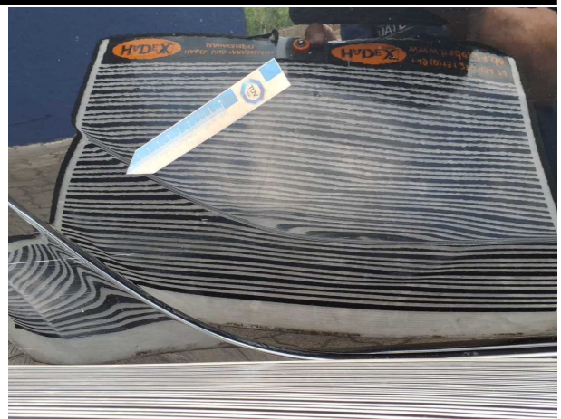
Beschädigung #8: Tür hinten rechts: Tür - Delle / Lackschad... - instandsetzen und lackieren
