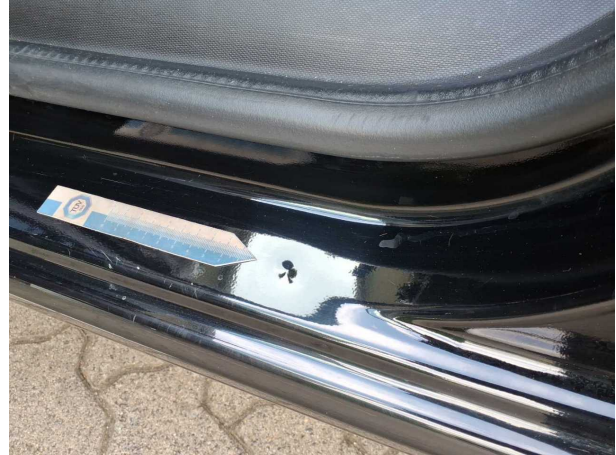
Beschädigung #1: Schweller links: Einstieg - Delle(n) - sanft instandsetzen
