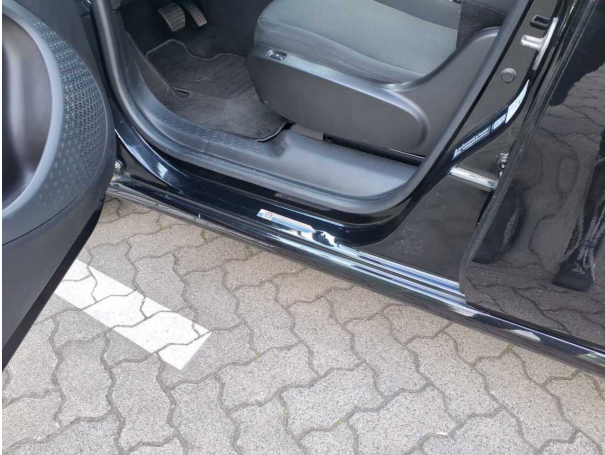
Beschädigung #1: Schweller links: Einstieg - Delle(n) - sanft instandsetzen
