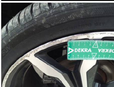
Pneu / Arrière Droit / Déchiré
