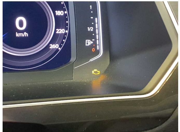
Damage 10: Engine: Engine (Motorkontrolle leuchtet, nicht fahrbereit) - Specify findings - Perform diagnosis
