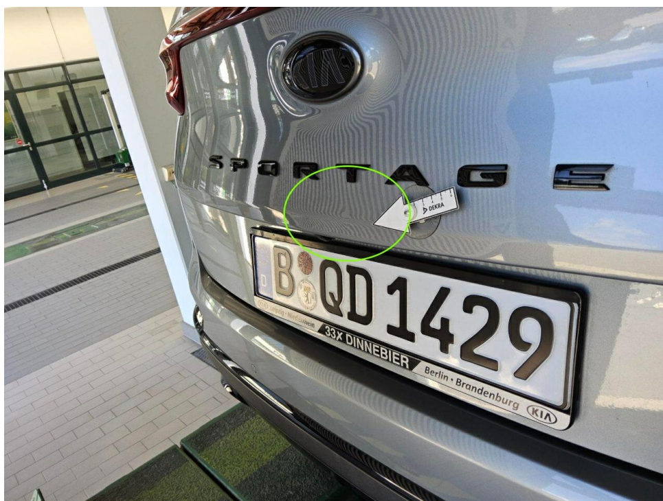
Bild 8 : Heckklappe, eingedellt, drücken
