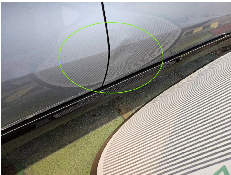
Bild 26 : Tür vorne rechts, deformiert, Tür hinten rechts, eingedellt
