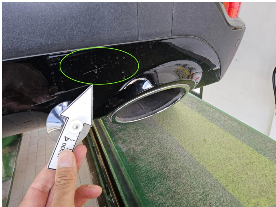
Bild 10 : Heckschürze hinten unten Lackierung, zerkratzt, lackieren
