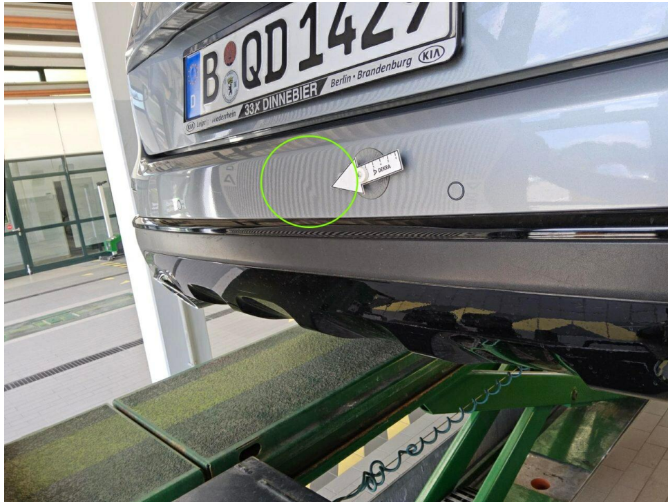
Bild 9 : Stoßfänger hinten, verformt, smart repair
