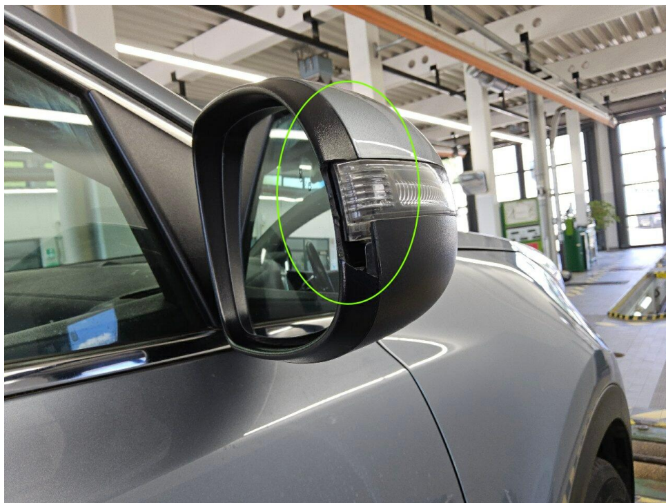
Bild 25 : Außenspiegel Rahmen rechts, beschädigt
