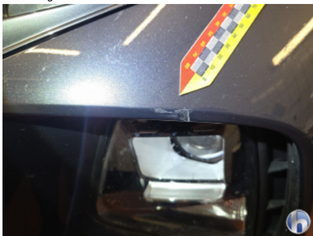
2. Stoßfänger Vorne Kratzer - Lackieren
