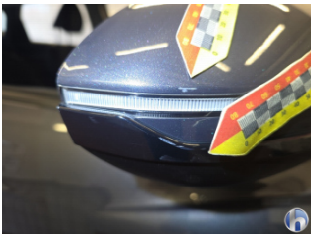
8. Außenspiegel Gehäuse - Rechts Kratzer - Smart Repair
