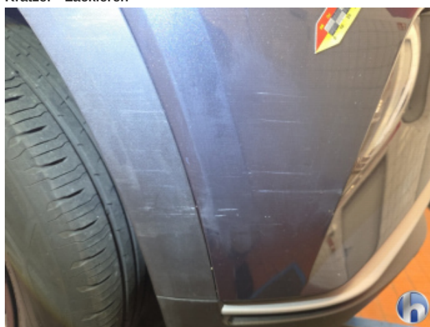
2. Stoßfänger Vorne Kratzer - Lackieren
