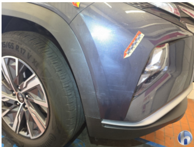
2. Stoßfänger Vorne Kratzer - Lackieren
