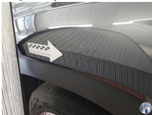
11. Kotflügel Vorne - Rechts Beschädigt - Instandsetzen und Lackieren
