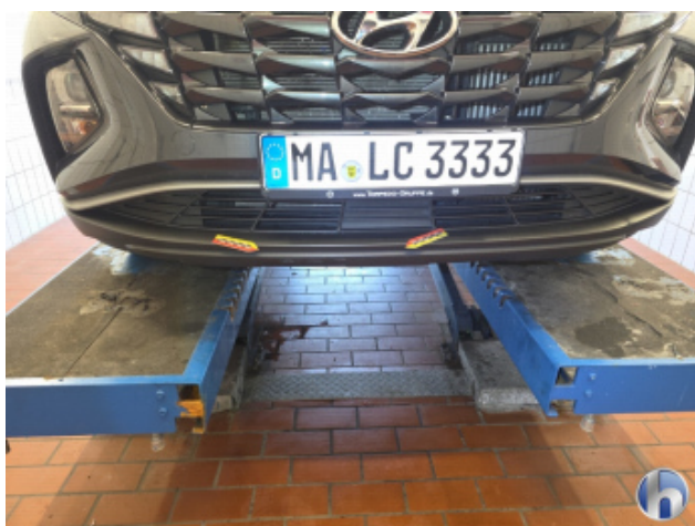
2. Stoßfänger Vorne Kratzer - Lackieren
