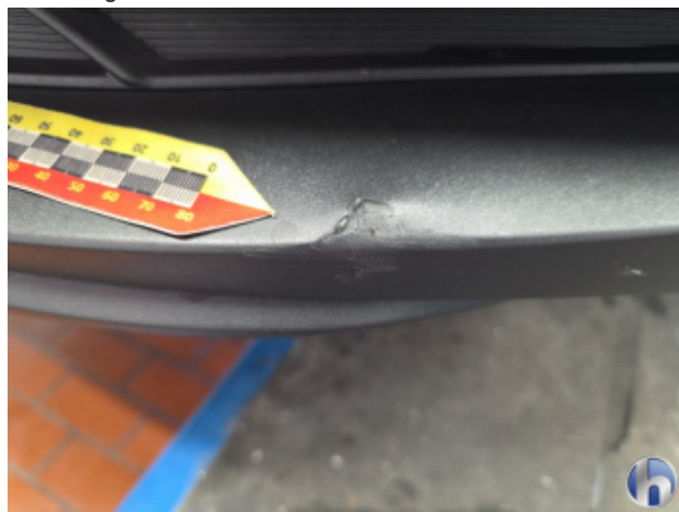
12. Frontspoiler Beschädigt - Erneuern
