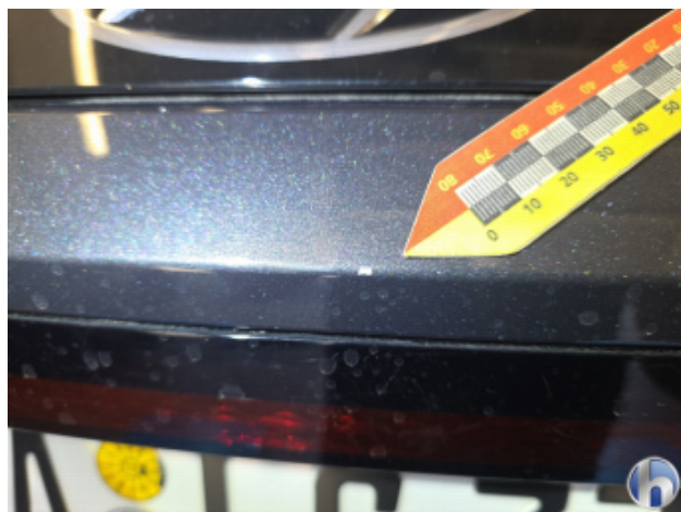
6. Heckklappe Kratzer Tief Bis Grundierung - Smart Repair
