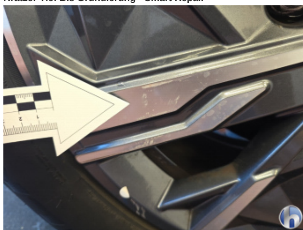
7. Felge Hinten - Rechts Kratzer - Smart Repair
