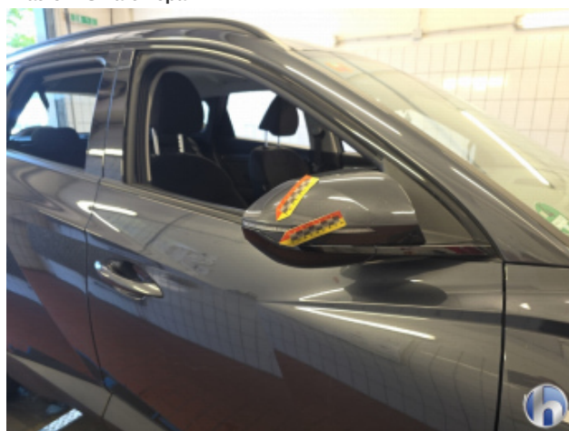
8. Außenspiegel Gehäuse - Rechts Kratzer - Smart Repair
