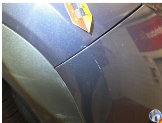
2. Stoßfänger Vorne Kratzer - Lackieren
