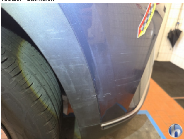
2. Stoßfänger Vorne Kratzer - Lackieren
