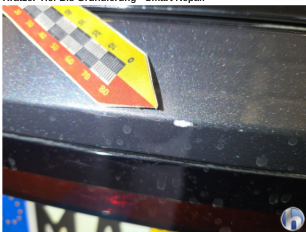
6. Heckklappe Kratzer Tief Bis Grundierung - Smart Repair
