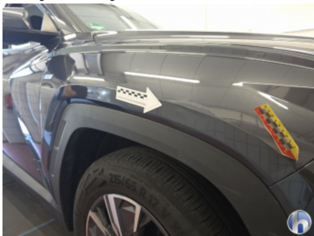
11. Kotflügel Vorne - Rechts Beschädigt - Instandsetzen und Lackieren
