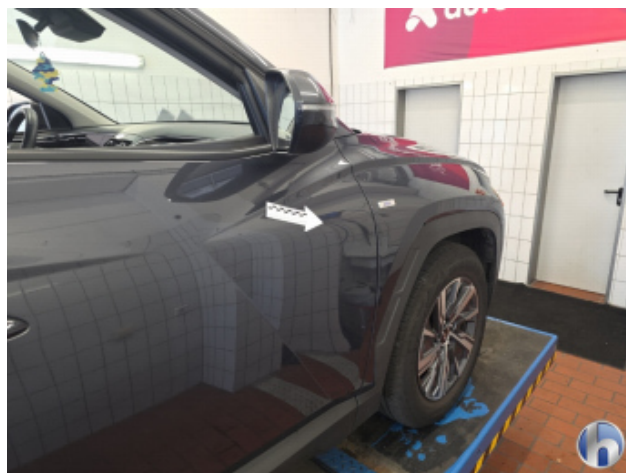
3. Tür Vorne - Rechts 1 Delle - Sanft Instandsetzen
