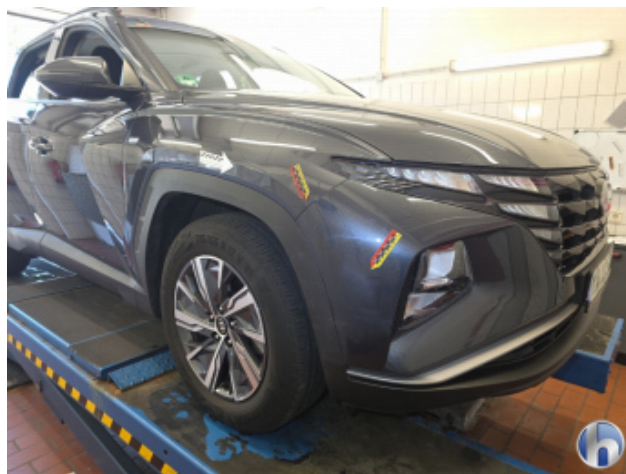
2. Stoßfänger Vorne Kratzer - Lackieren
