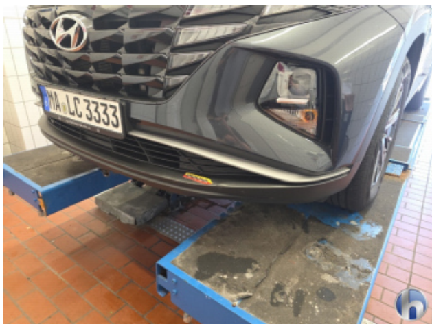
12. Frontspoiler Beschädigt - Erneuern
