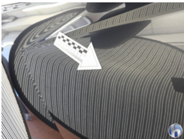
3. Tür Vorne - Rechts 1 Delle - Sanft Instandsetzen
