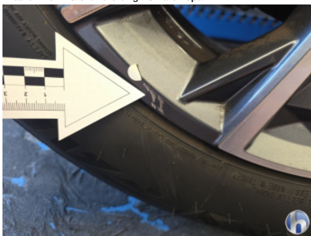
7. Felge Hinten - Rechts Kratzer - Smart Repair
