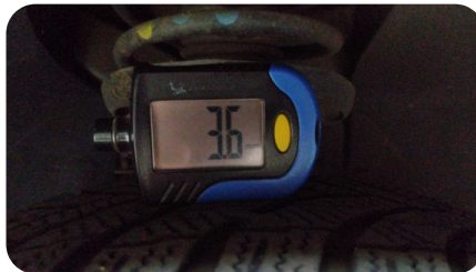
Photo de la mesure de l'usure du pneu avant droit
