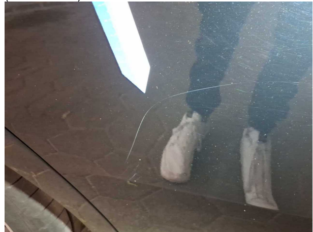
Beschädigung #5: Tür hinten rechts: Tür - Kratzer - lackieren
