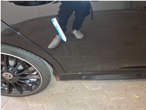
Beschädigung #5: Tür hinten rechts: Tür - Kratzer - lackieren
