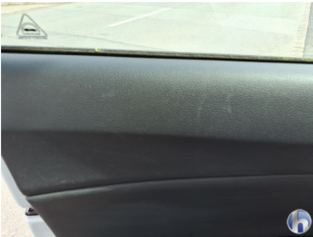
4. Verkleidung Verschmutzt - Reinigen
