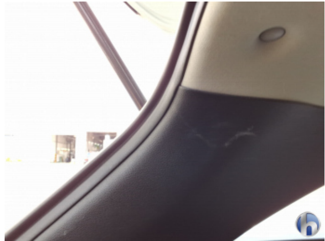
4. Verkleidung Verschmutzt - Reinigen
