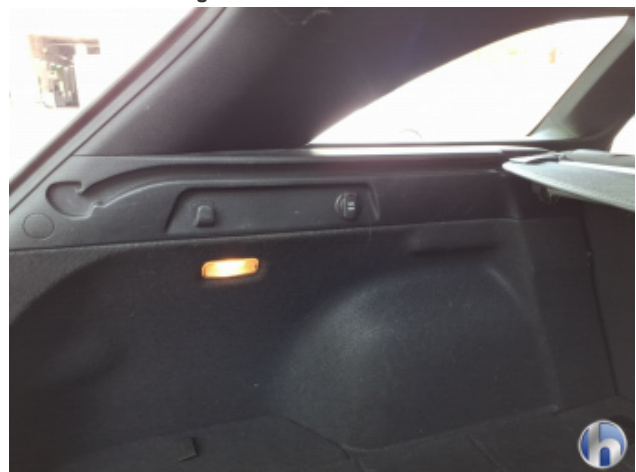
4. Verkleidung Verschmutzt - Reinigen
