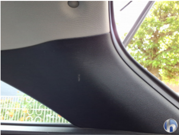
4. Verkleidung Verschmutzt - Reinigen
