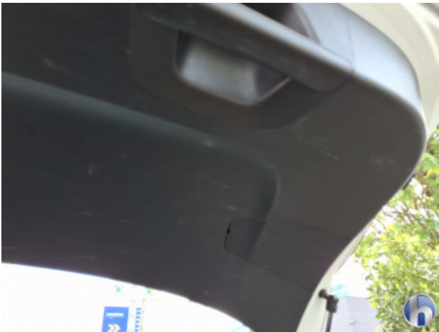
4. Verkleidung Verschmutzt - Reinigen
