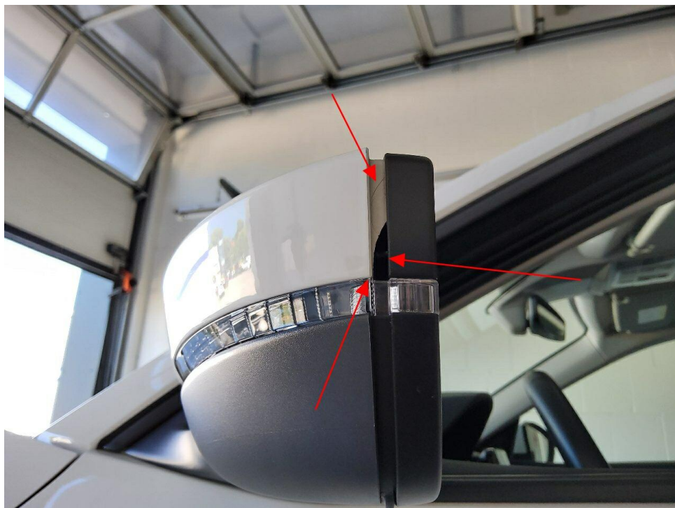
Bild 16 : Außenspiegel links, Gehäuse gebrochen
