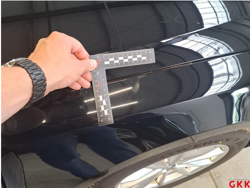
Bild 15. Kotflügel vorne rechts, Reparaturmangel, lackieren
