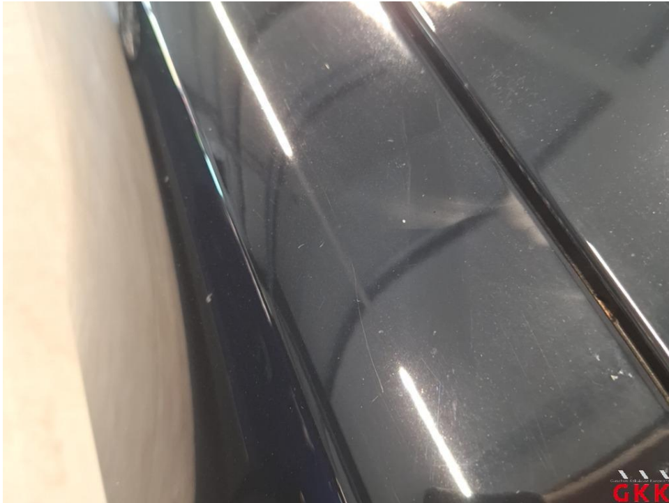
Bild 17. Kotflügel vorne rechts, Reparaturmangel, lackieren
