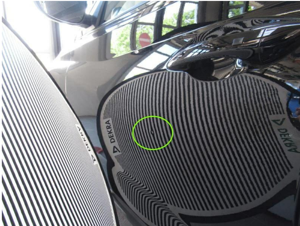
Bild 19 : Tür vorne links, eingedellt, drücken
