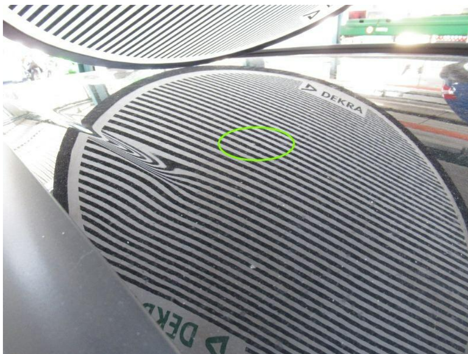
Bild 18 : Dach, eingedellt, Gebrauchsspur
