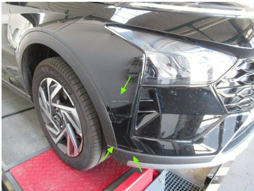
Bild 20 : Schaden vorne rechts (Stoßfänger Lackierung zerkratzt und Blende Radlaufverkleidung zerkratzt und gekerbt)
