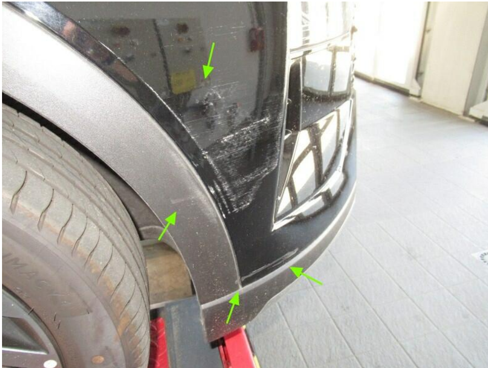
Bild 21 : Schaden vorne rechts (Stoßfänger Lackierung zerkratzt und Blende Radlaufverkleidung zerkratzt und gekerbt)
