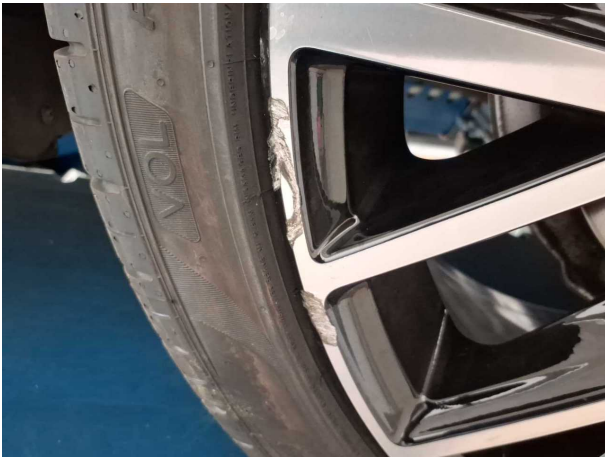
Beschädigung #9: Rad/Reifen: Leichtmetallfelge vorn rechts (Materialabrieb) - Kratzer - erneuern
