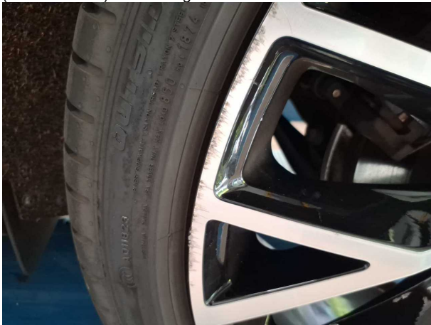
Beschädigung #11: Rad/Reifen: Leichtmetallfelge hinten links - Kratzer - erneuern
