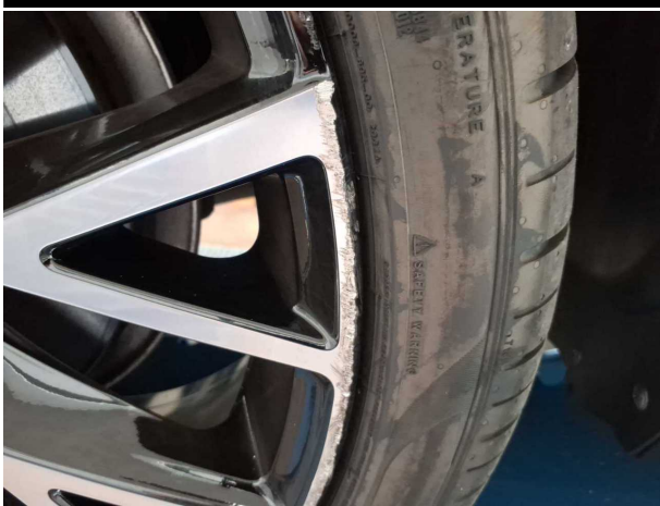
Beschädigung #10: Rad/Reifen: Leichtmetallfelge vorn links (Materialabrieb) - beschädigt - erneuern
