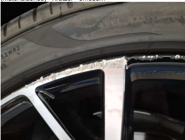
Beschädigung #10: Rad/Reifen: Leichtmetallfelge vorn links (Materialabrieb) - beschädigt - erneuern
