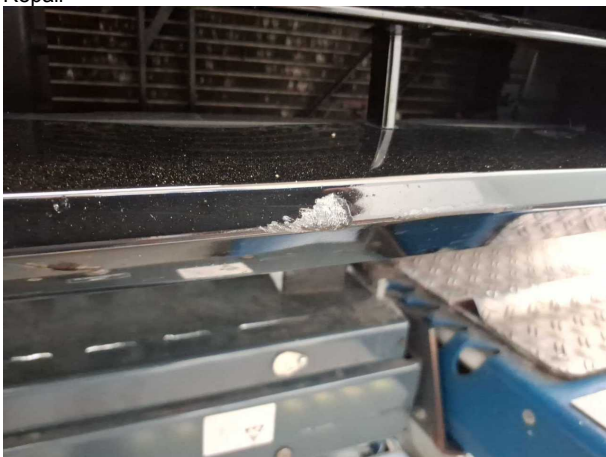
Beschädigung #7: Stossfänger vorn: Spoiler - Kratzer - erneuern
