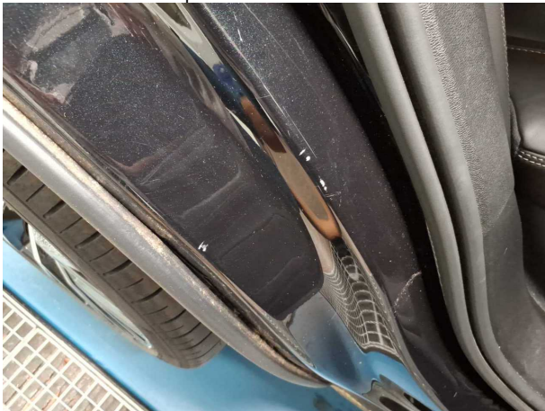
Beschädigung #5: Seitenwand rechts: Einstieg - Kratzer - Smart Repair
