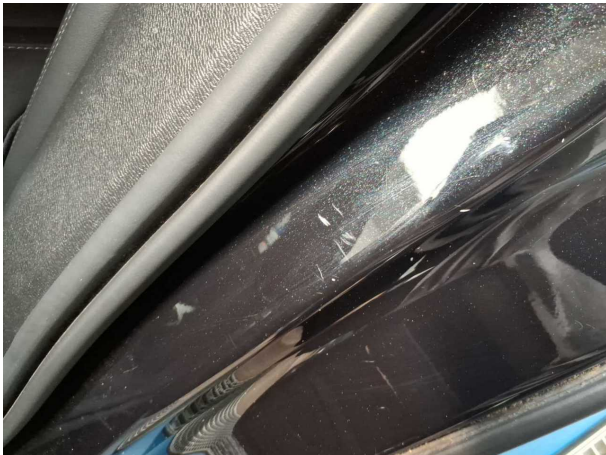
Beschädigung #2: Seitenwand links: Einstieg - Kratzer - Smart Repair
