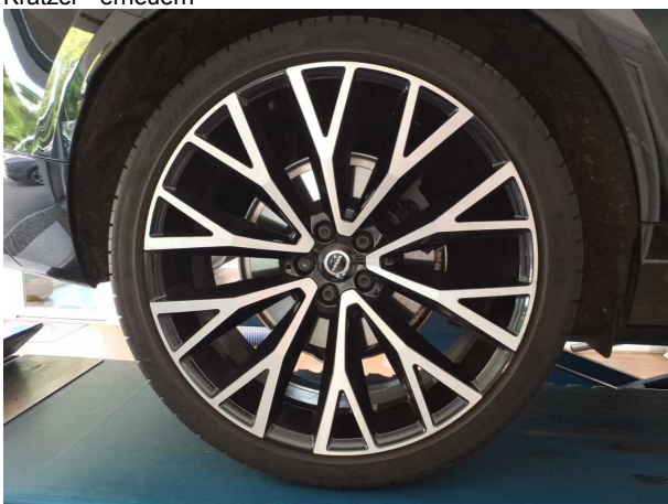
Beschädigung #12: Rad/Reifen: Leichtmetallfelge hinten rechts - Kratzer - erneuern
