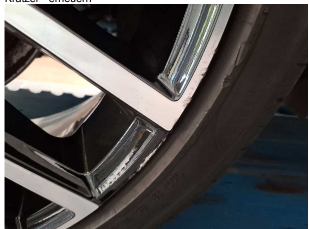
Beschädigung #12: Rad/Reifen: Leichtmetallfelge hinten rechts - Kratzer - erneuern
