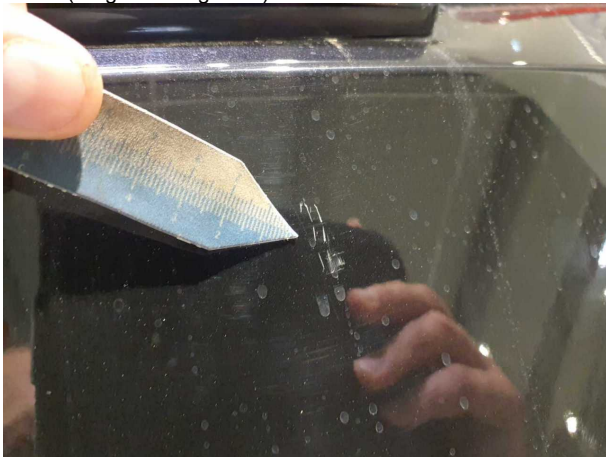
Beschädigung #4: Heckklappe/-tür: Heckklappe - verkratzt / verschürft - lackieren
