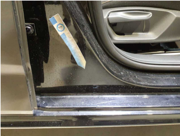
Beschädigung #1: Karosserie: Typschild - fehlt - erneuern
