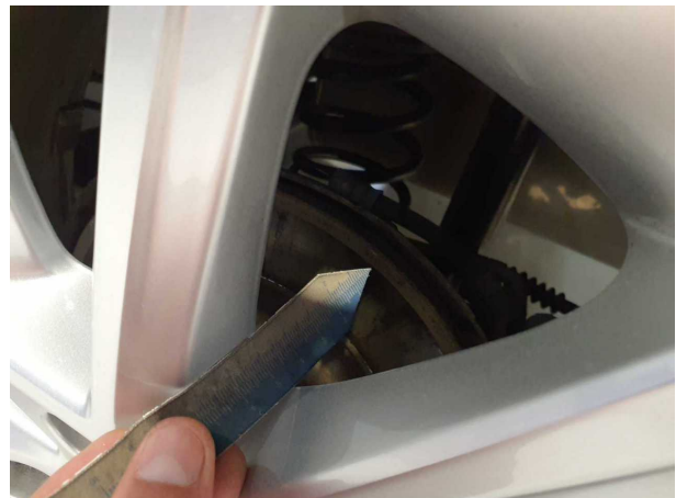
Beschädigung #3: Bremsanlage: Bremsscheiben und Beläge hinten (Tragbild mangelhaft) - verschlissen - erneuern
