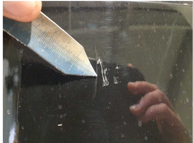
Beschädigung #4: Heckklappe/-tür: Heckklappe - verkratzt / verschürft - lackieren
