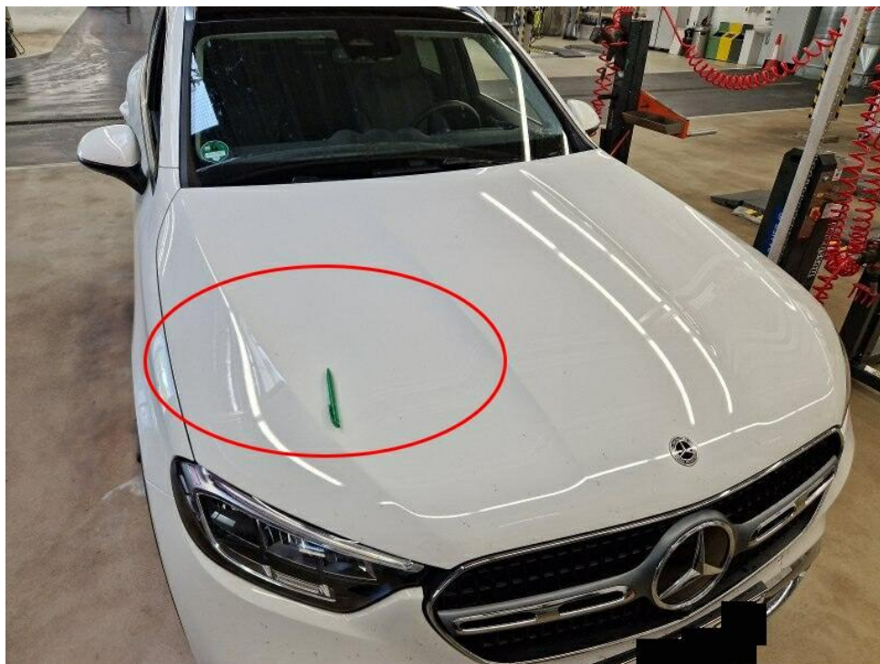
Bild 13 : Motorhaube, eingedellt, Gebrauchsspur
