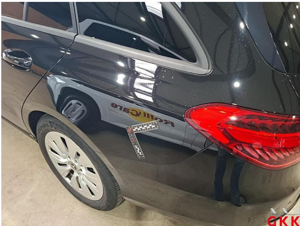
Bild 24. Seitenwand links, bis 3 Dellen / Bauteil, kalt drücken
