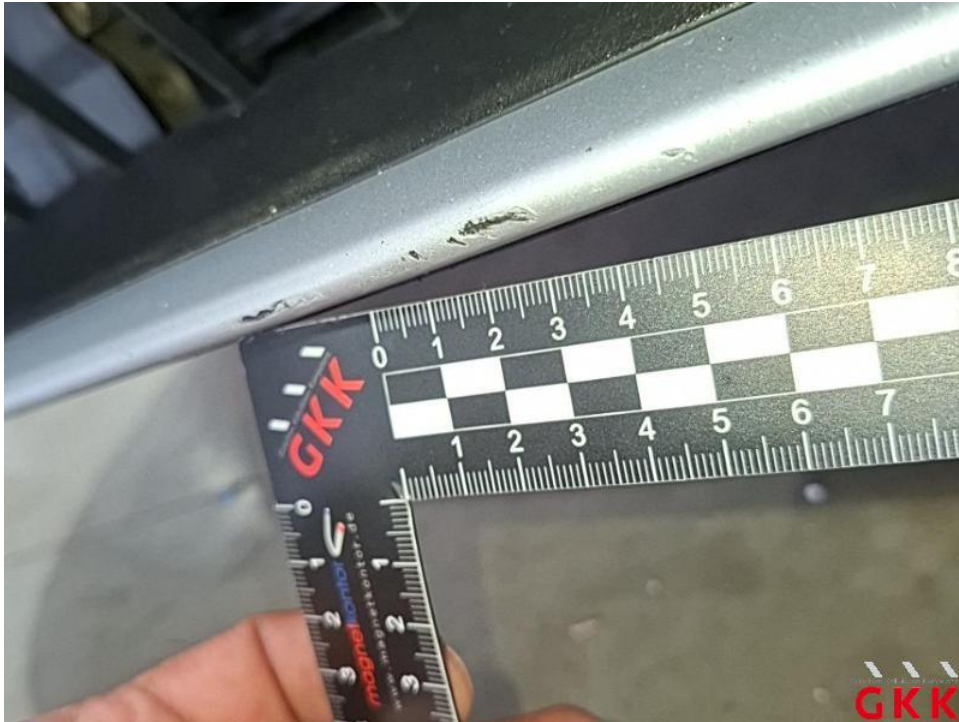
Bild 17. Stoßfänger vorne, Leiste -mittig-, beschädigt, ersetzen
