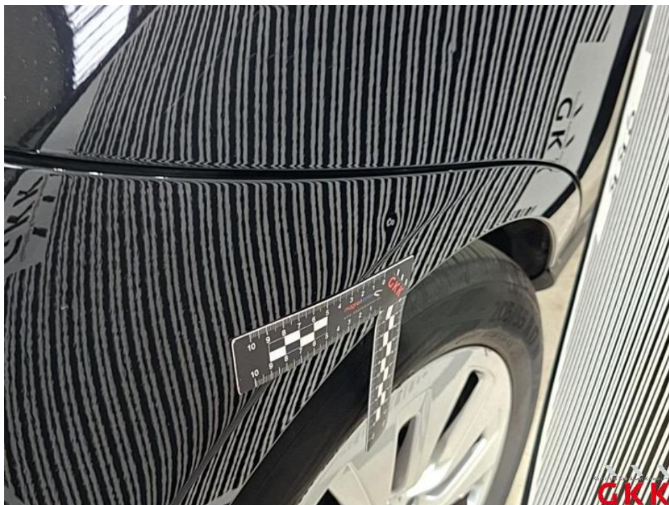
Bild 33. Seitenwand rechts, bis 3 Dellen / Bauteil, kalt drücken
