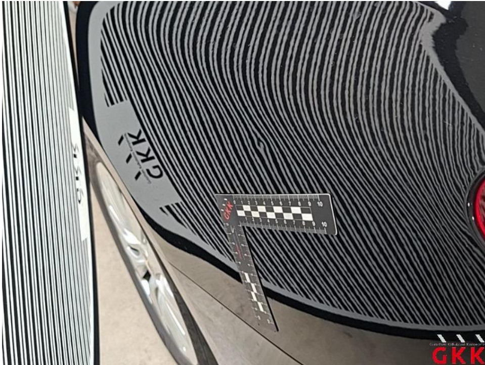
Bild 25. Seitenwand links, bis 3 Dellen / Bauteil, kalt drücken
