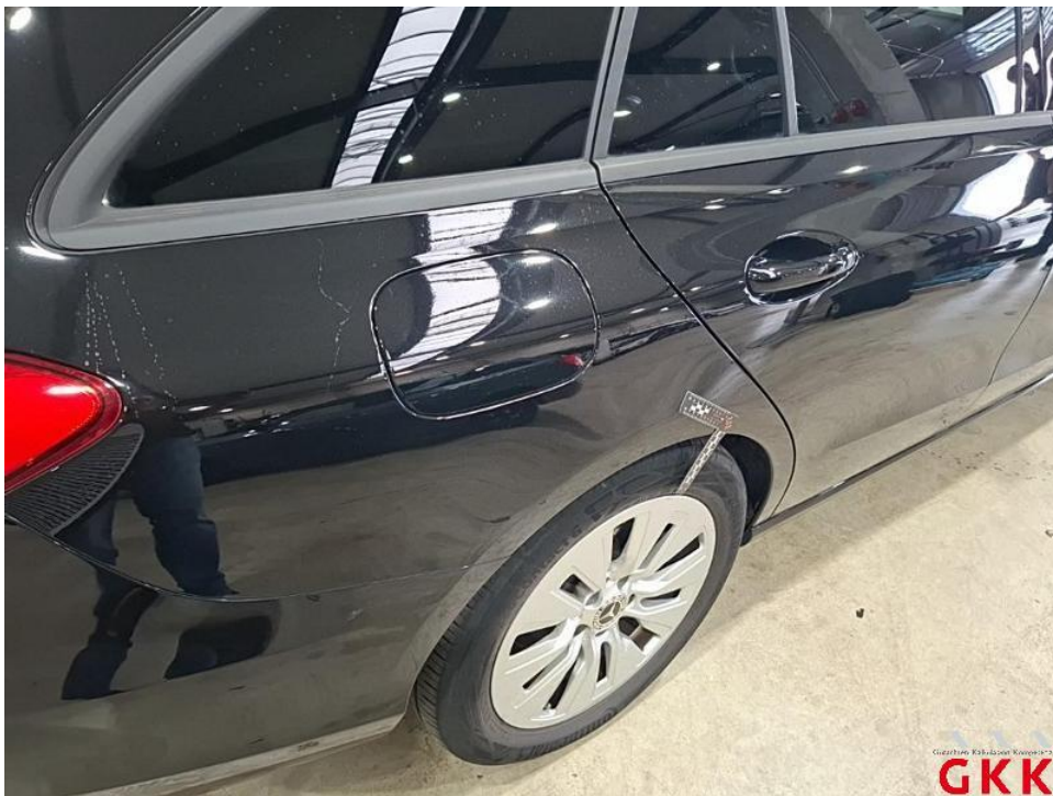
Bild 32. Seitenwand rechts, bis 3 Dellen / Bauteil, kalt drücken
