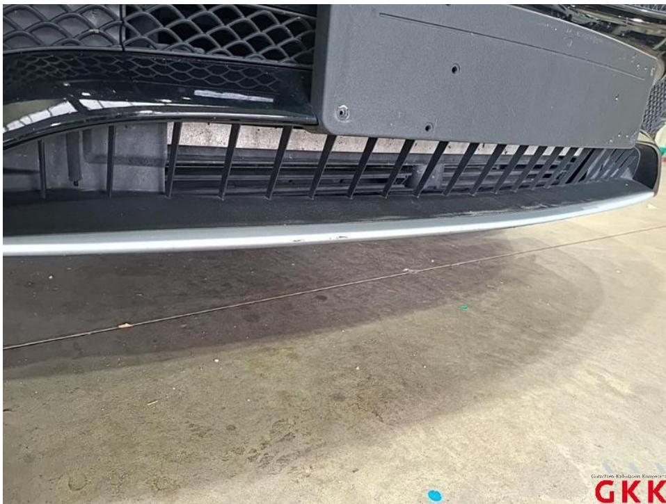
Bild 16. Stoßfänger vorne, Leiste -mittig-, beschädigt, ersetzen
