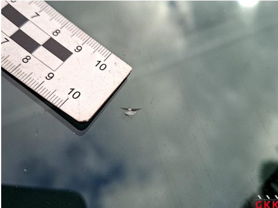
Bild 15. Frontscheibe, mit Regensensor und Frontkamera, Steinschlag, ersetzen
