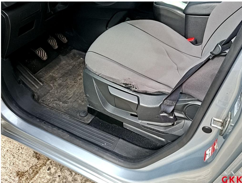
Bild 18. Sitz vorne links, Verkleidung, verkratzt, ersetzen
