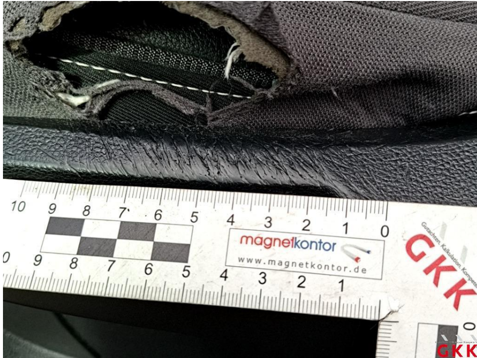
Bild 19. Sitz vorne links, Verkleidung, verkratzt, ersetzen
