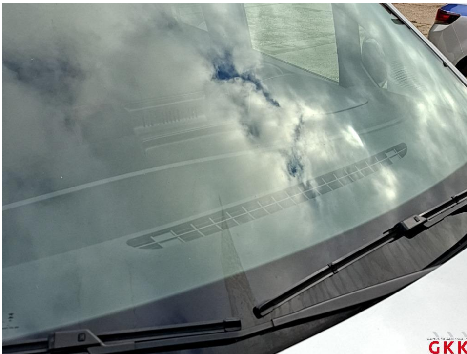
Bild 14. Frontscheibe, mit Regensensor und Frontkamera, Steinschlag, ersetzen
