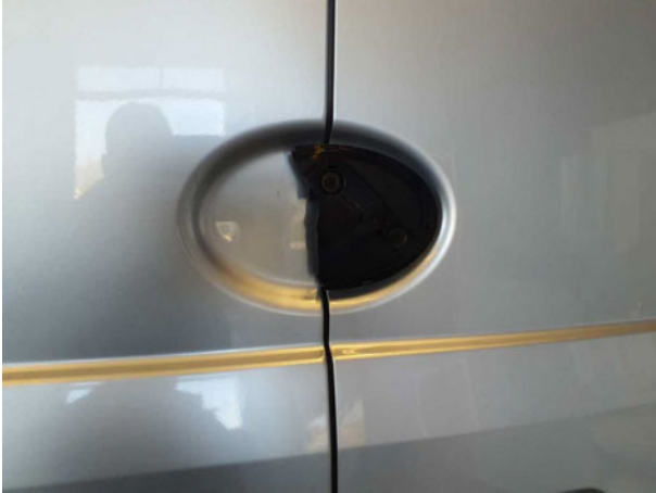
Beschädigung #2: Heckklappe/-tür: Emblem - gebrochen / gerissen - erneuern
