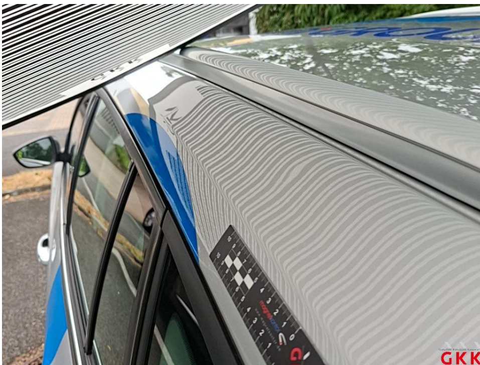
Bild 20. Dach, Holm links, beschädigt, kalt drücken
