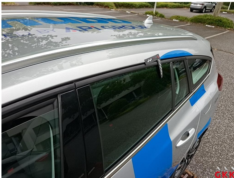
Bild 18. Dach, Holm links, beschädigt, kalt drücken
