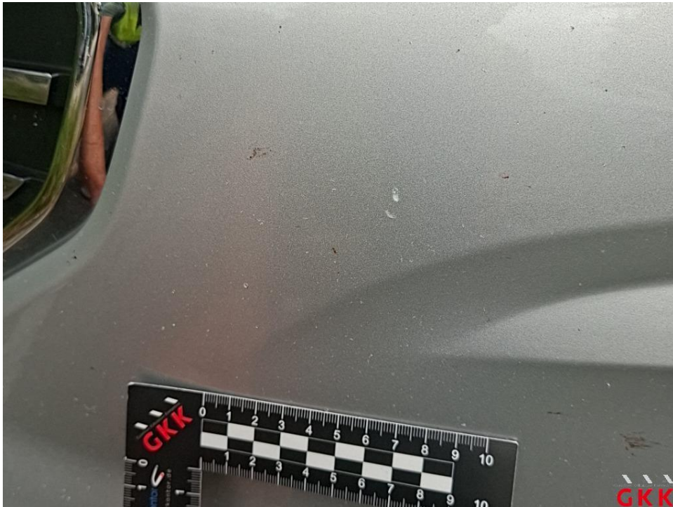
Bild 14. Stoßfänger vorne, Verkleidung -lackiert-, Steinschlag, auslegen, schleifen, polieren
