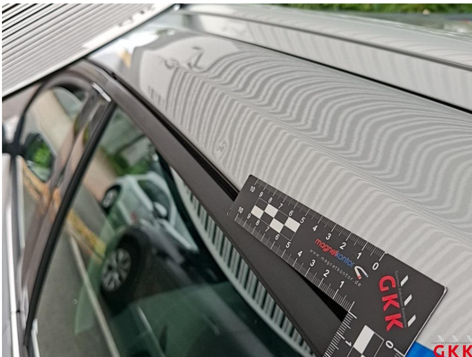
Bild 19. Dach, Holm links, beschädigt, kalt drücken
